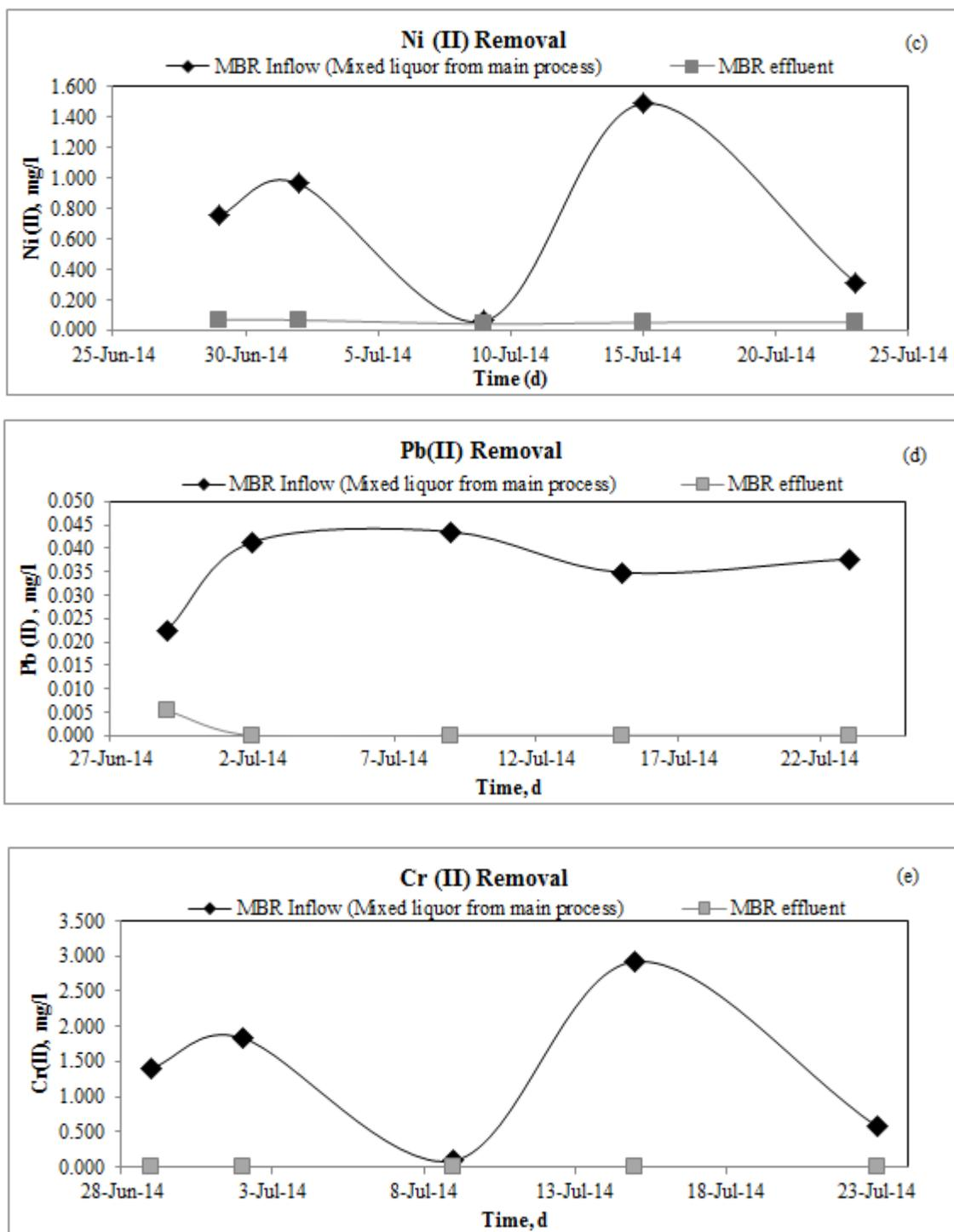
**Figure 32:** Influent and effluent concentration variations (a) Zn(II), (b) Cu(II), (c) Ni(II), (d) Pb(II) and (e) Cr(III)
