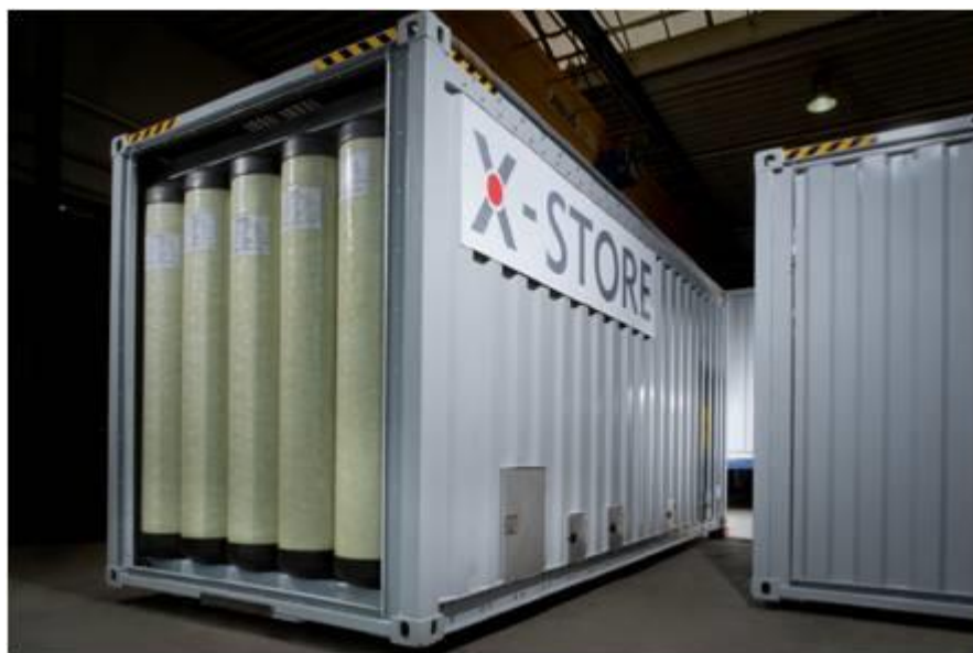
Kuva 7. Satelliittitankkausaseman kaasun varastointikontti (RAP)
