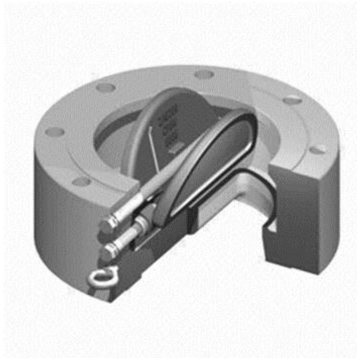
Kuva 3. Kaksoisläppärakenteinen takaiskuventtiili. (Global Sources 2015.)
