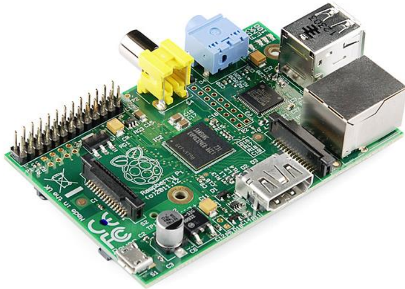
Kuva 2.1 Raspberry Pi B-malli. (Zagros Robotics 2016)
