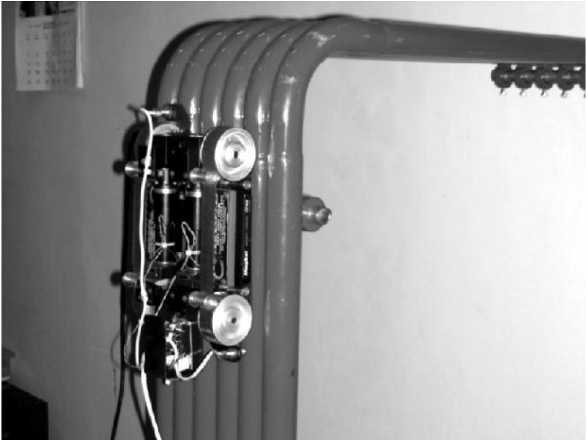
Kuva 3. Putkiston ulkopuolella liikkuva robotti testiolosuhteissa (Badodkar et al. 2009, s. 34).
