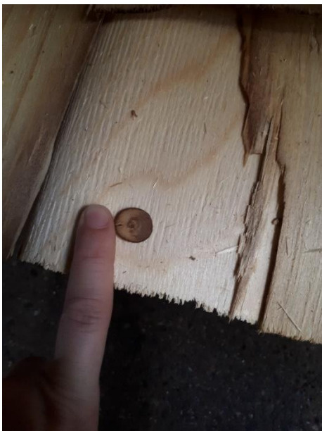
Kuva 33. Kosteuslajittelukameran kohdalle tippunut oksa, joka aiheutti viilujen päätyamisen perälaatikkoon hävikkiin.
