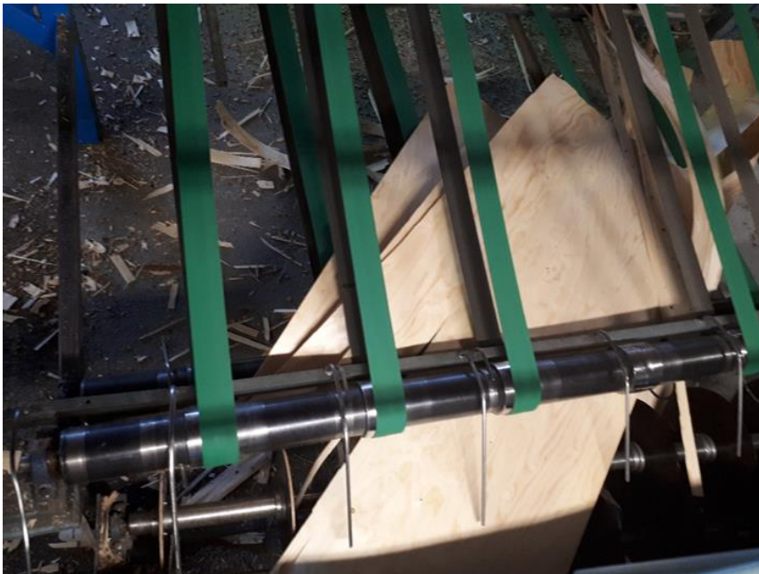
Kuva 31. Viilu revennyt ja jäänyt jumiin hihnojen väliin.
