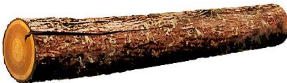
Kuva 16. Tukissa pintahalkeama (Tukkipuu).
