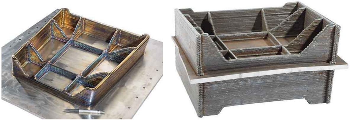
Kuva 8. Titaanista (vasemmalla) ja teräksestä (oikealla) valmistetut lentokoneen laskutelineen osan aihiot (WAAMMat 2020a).
