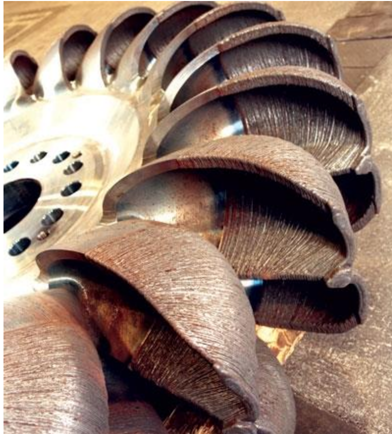
Kuva 7. Lankapohjaisella suorakerrostuksella valmistettuja Pelton-turbiinin kauhoja (Appleyard 2012).
