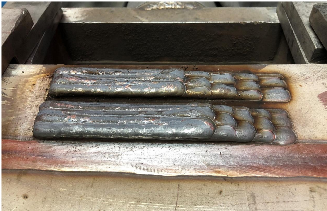
Kuva 21. Ennen varsinaisen koekappaleen tulostusta suoritettut tulostukset oikeiden parametrien löytämiseen.
