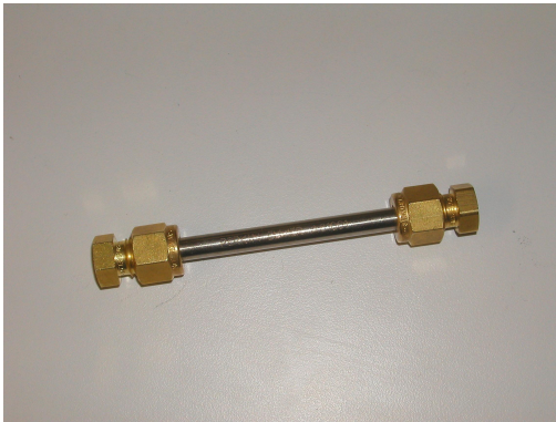
Kuva 12. VOC-näytteiden keräyksessä käytetty Perkin-Elmerin Tenax GR-putki, joka on suljettu Swagelok-korkeilla.
