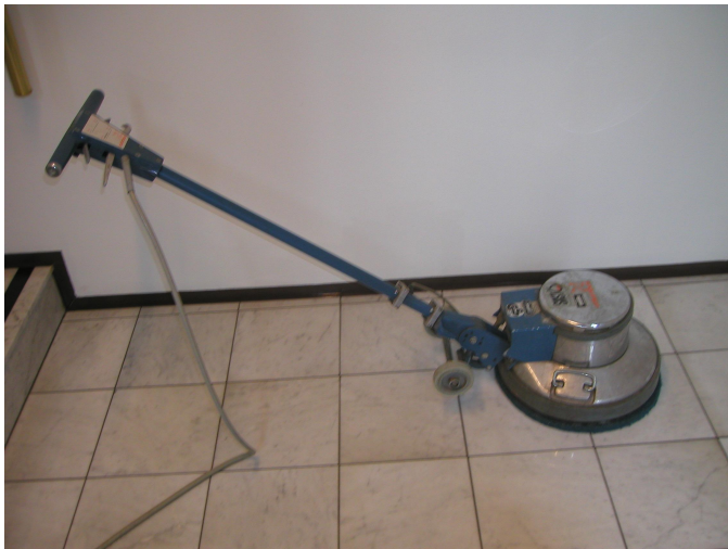
Kuva 4. Lattianvahauskohdeissa lattianpesussa käytetty lattianhoitokone.
