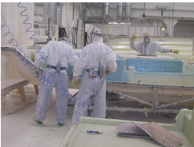
Kuva 6. Kohteessa Muovituotetehdas #1 työntekijät valmistavat lasikuitutuotteita ruiskulaminoinnilla. Kuvassa näkyvät työntekijöiden käyttämät suojavarusteet ja keskimmaisella henkilöllä on lisäksi vyöllään mitauksessa käytetty pumppu.
