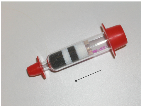
Kuva 9. TBEP- ja TEHP-näytteiden keräyksessä käytetty OVS-keräin tulpattuna (nuoli osoittaa ilmanäytteen keräyssuunnan).
