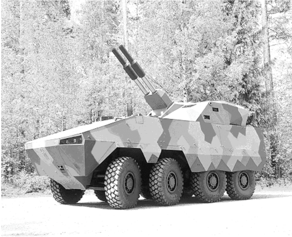
Kuva 21. AMOS-kranaatinheitinjärjestelmä integroituna AMV 8x8 -panssariajoneuvoon
