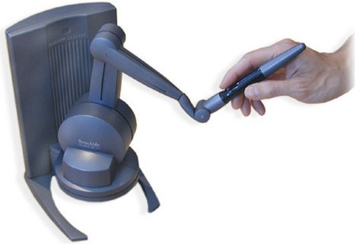
Kuva 1: Käsivarsi periaatteella toteutettu haptiikkalaite (Inition 2006).
