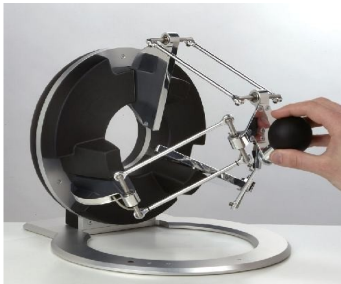
Kuva 2: Rinnakkaisrakenteella toteutettu haptiikkalaite (Inition 2005).
