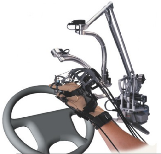
Kuva 4: Datahanskan ja käsivarsirobotin yhdistelmä (Inition 2008b).
