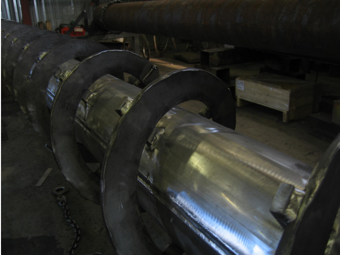
KUVA 2-4. RUUVIKULJETTIMEN RUUVI. (Laitex Oy 2007b.)
