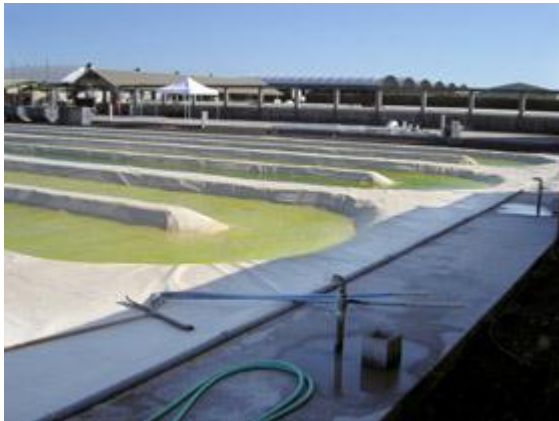
Kuva 4. HR Biopetroleumin pilottilaitoksen rengasaltaita Havaijilla (HR BioPetroleum 2008b)
