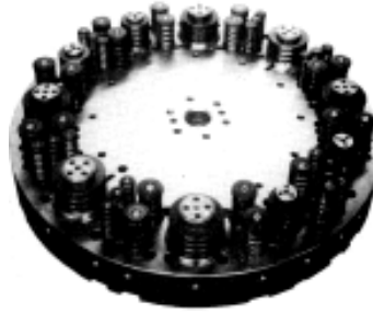
Kuva 4. Levytyökeskuksen työkalurevolveri (Töyrä, Vaurio & Tajonlahti 1988, s.18).
