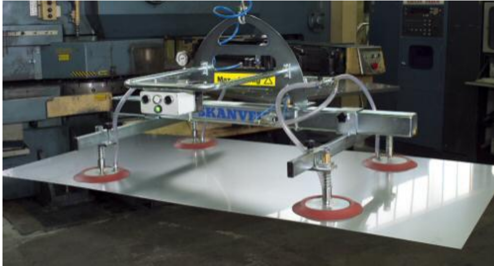
Kuva 2. Neljällä imukupilla toimiva alipainetarrain. (Skanveir 2009)
