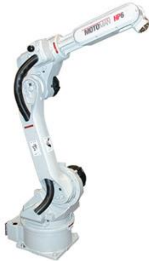
Kuva 11. Kiertyvänivelinen 6 vapausasteen robotti. (Motoman 2009)
