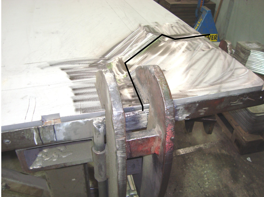
Kuva 30. Käsinsitauksessa käytetty hydraulinen kulmapalan ja suodinlevyn kiinnittäminen. Kuvassa musta viiva kuvaa hitsatun railon sijaintia.
