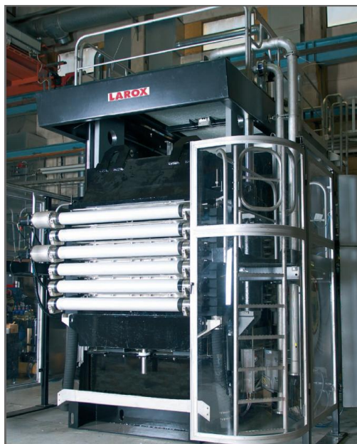
Kuva 1. Larox PF 60 –sarjan suodatin, jossa käytetään 6 m 2 suodinlevyjä. (Larox 2009)
