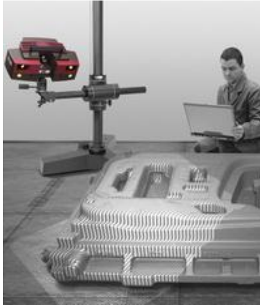
Kuva 10. GOM:n Atos 3D-stereokuvausprojektorin /21/.
