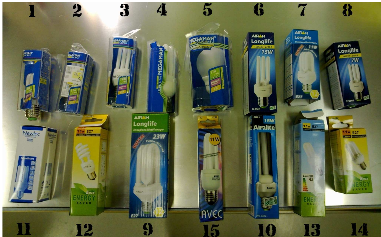
Kuva 2.2 Mittauksessa käytetyt pienloistelamput numeroituna taulukon 2.1 mukaisesti
