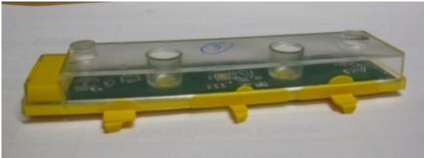
Kuva 1. EEMO-kappale, jossa on yhdistetty elektroniikkaa ruiskuvalettavaan tuotteeseen.
