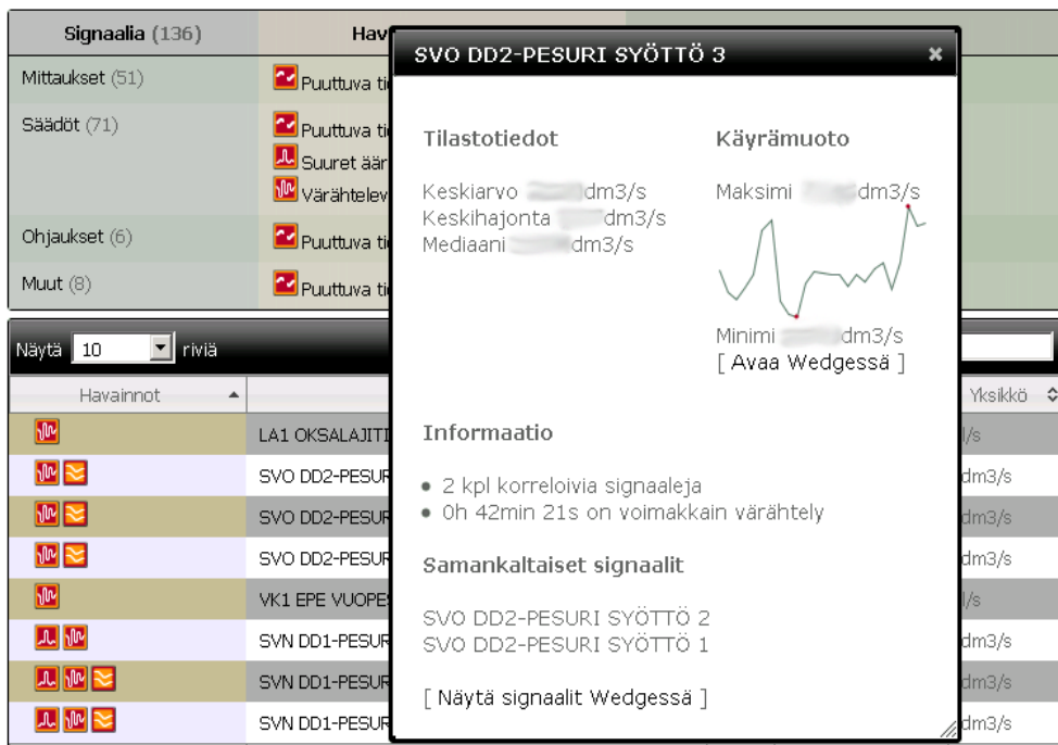
Kuva 6. Infoikkuna, joka sisältää signaalin tilastotiedot, käyrämuodon sekä muuta informaatiota, mitä analysointi on signaalista kyennyt havaitsemaan.
