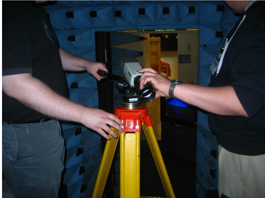
Kuva 6.4. Testattavaa laitteiston tarkkailuun käytetty videokamera. Videokameran kuvasignaali välitettiin reaaliaikaisesti testihuoneen ulkopuolelle virheiden havainnointiin.
