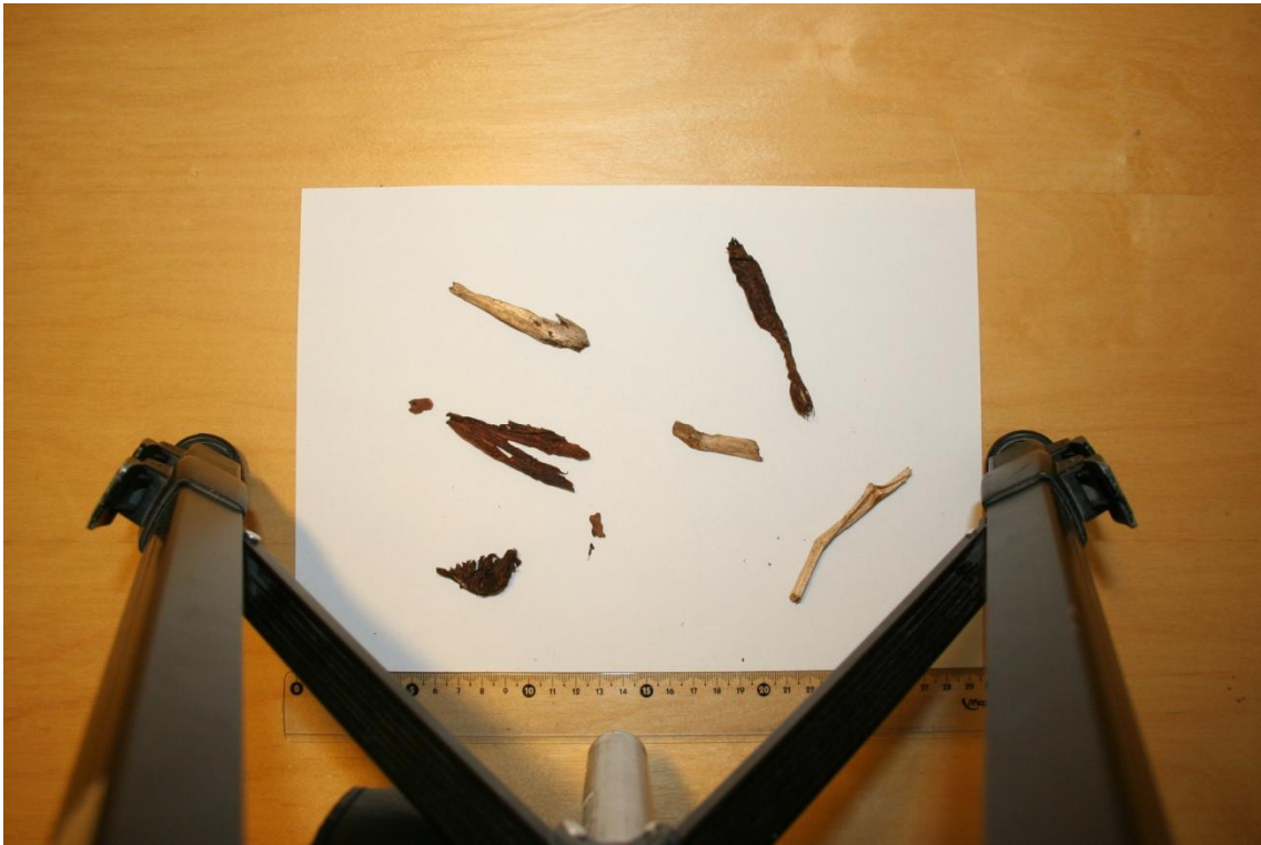
Kuva 40. Leijutettuja hakepartikkeleita(leijutusnopeus 6,1 m/s).
