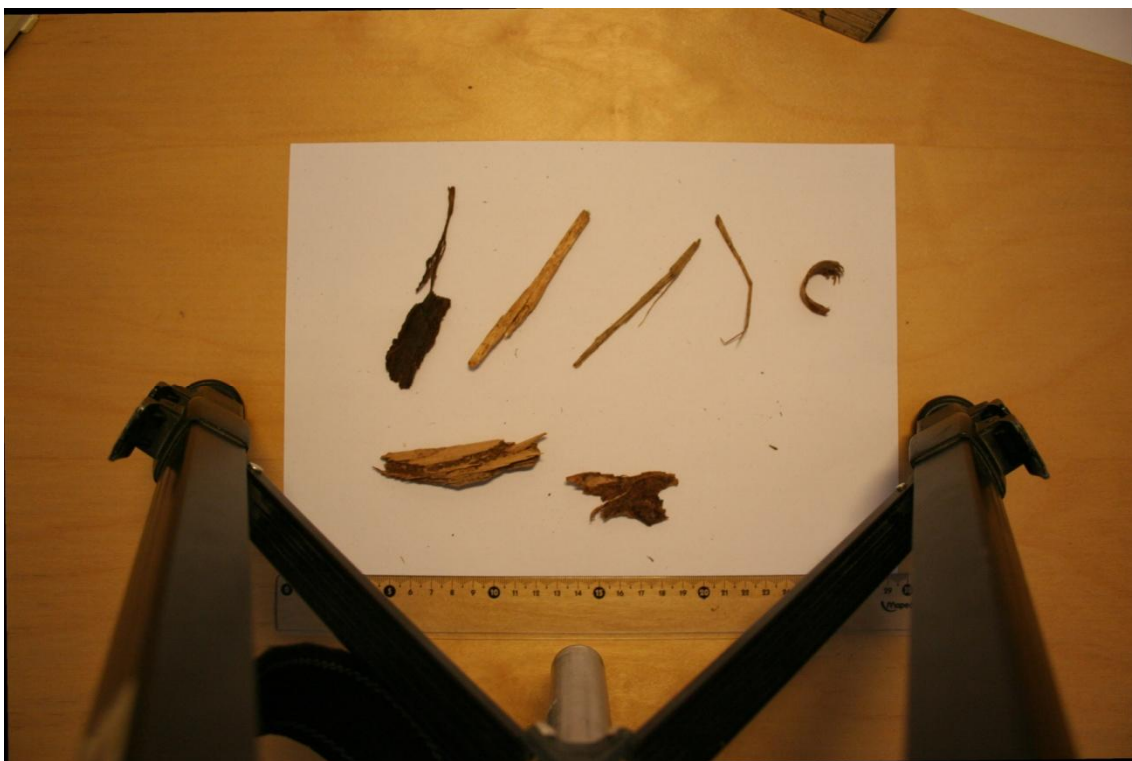
Kuva 28. Hakepartikkeleita 4 mm:n seualta.
