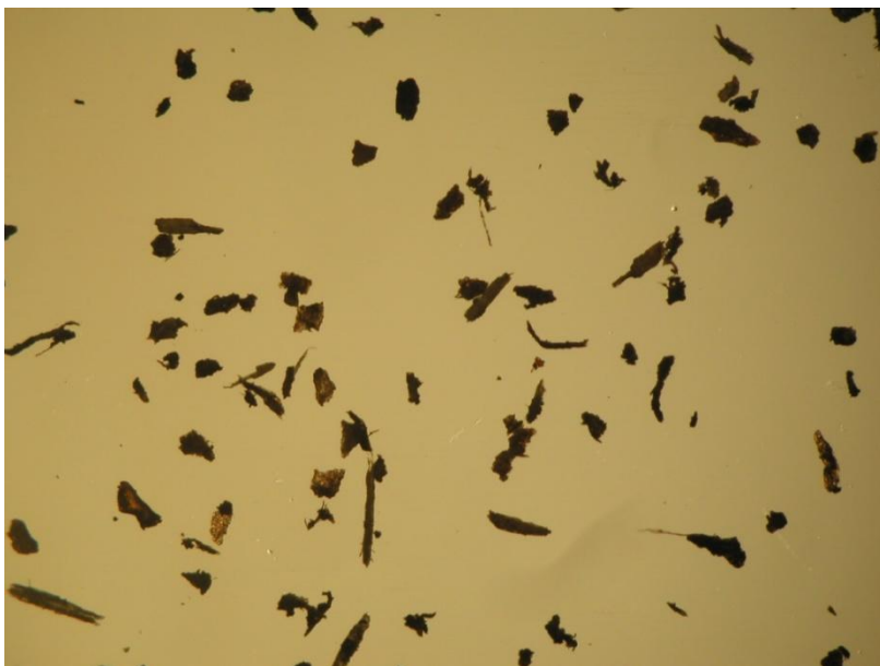
Kuva 14. Hakepartikkeleita 0,18 mm:n seualta, Suurenos 12,6-kertainen.
