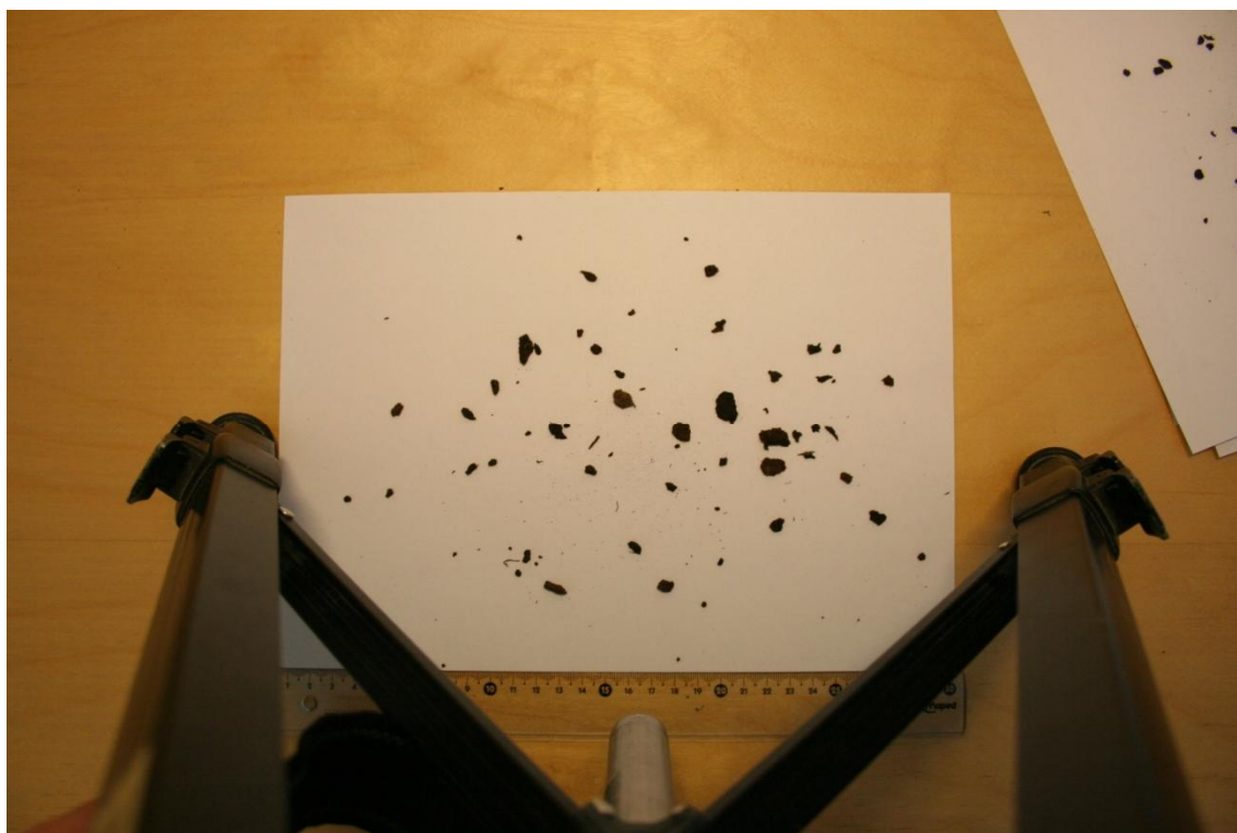
Kuva 31. Leijutettuja turvepartikkeleita(leijutusnopeus 4 m/s).
