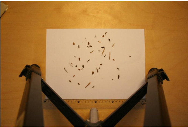
Kuva 16. Hakepartikkeleita 2 mm:n seualta.
