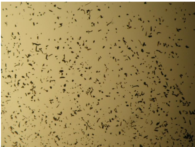
Kuva 15. Turvepartikkeleita seulan pohjalta. Suurenos 20-kertainen.
