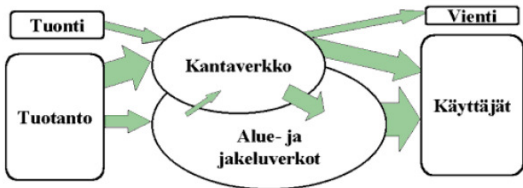
Kuva 14. Sähkön siirron ja jakelun toimijarakenne. (Partanen et al. 2011, 4.)
