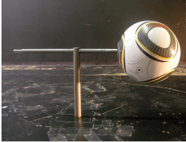
Kuva 6. Jabulani -pallon koejärjestely tuulitunnelissa (Alam, 2011, s. 191).
