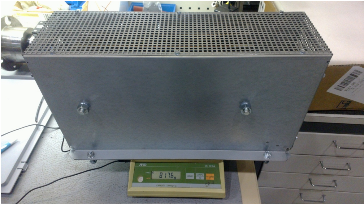
Kuva 6.7 Laboratoriotesteissä käytetty lämmitysvastus.
