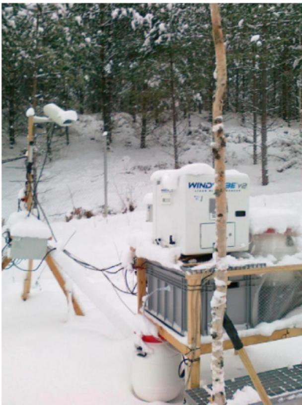
Kuva 2.3. Joutsenon mittauksissa käytetyn LIDAR-tutkan mittausjärjestelyt.
