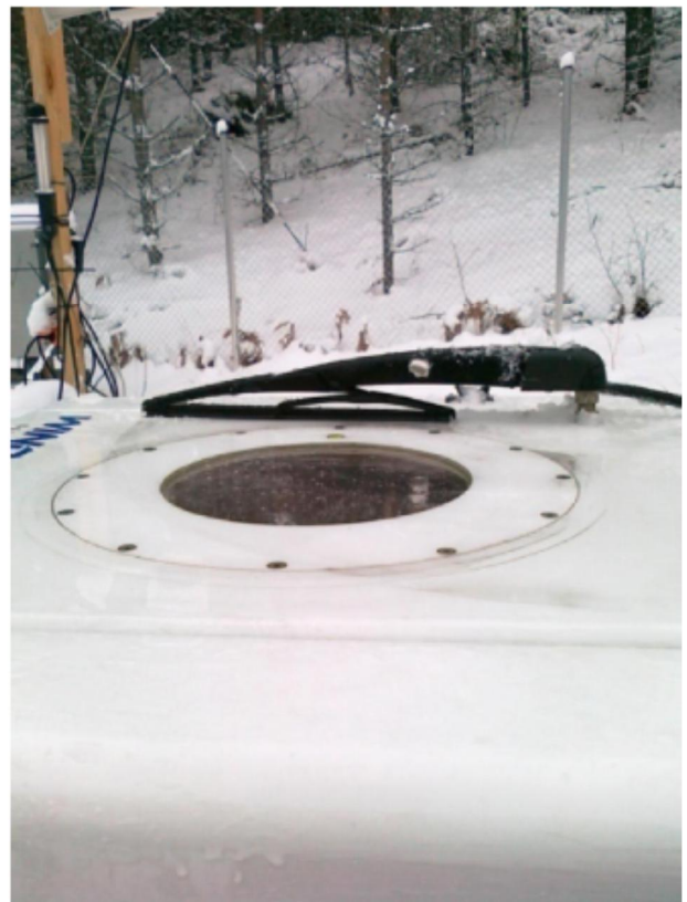
Kuva 2.3. Joutsenon mittauksissa käytetyn LIDAR-tutkan mittausjärjestelyt.
