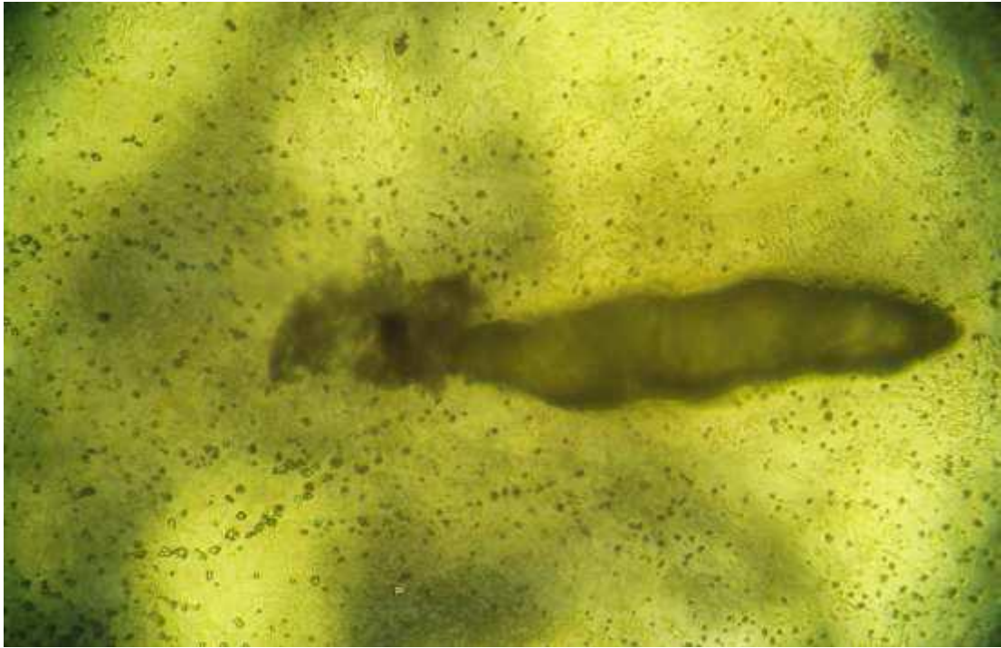
Kuva 8. Jäljenteessä havaittu mikrosärö. Suurennos noin 300x. (Salmi, P. 2009)
