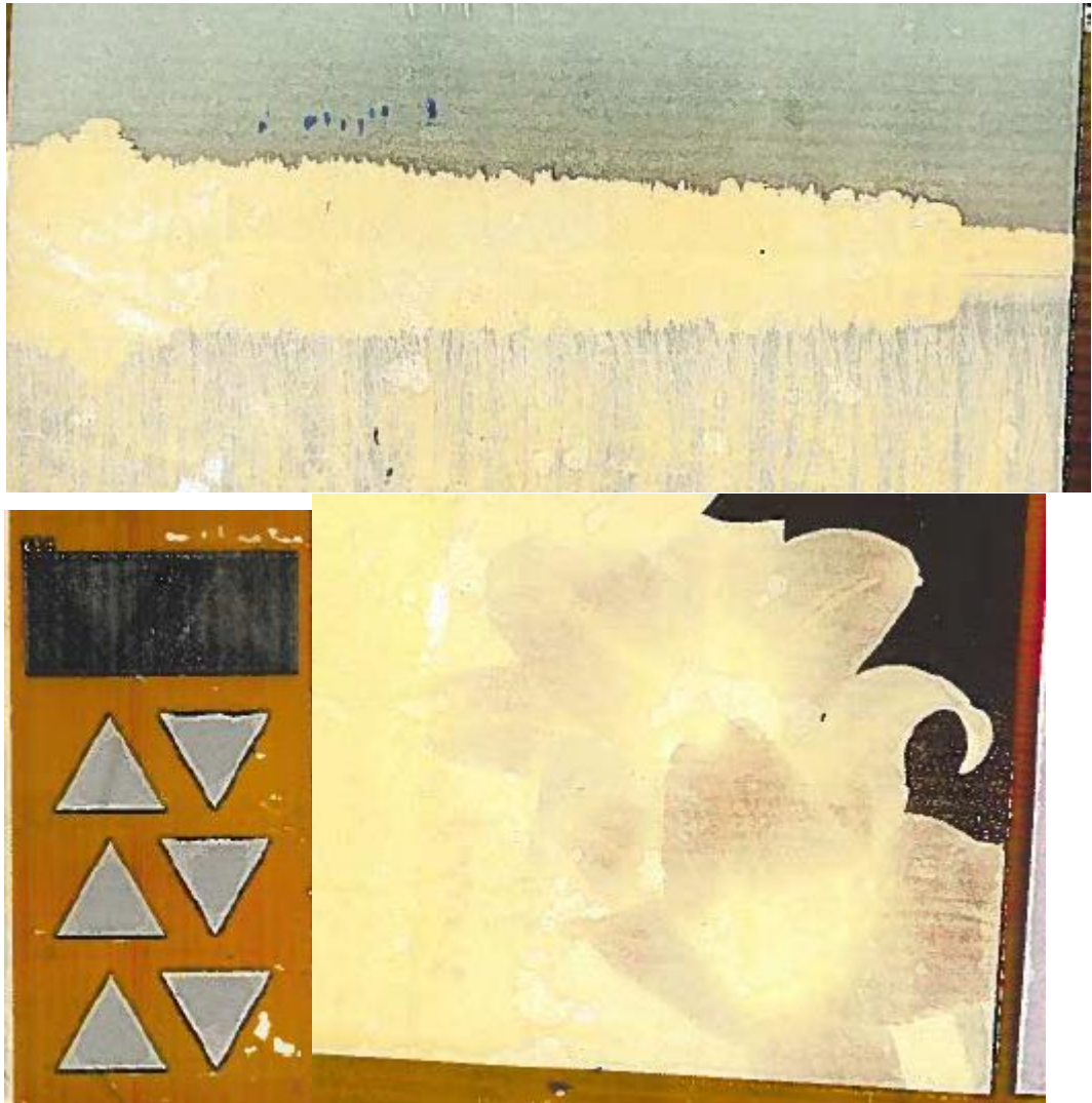
Kuva 2 Rullan kaksi kirkkaat teipit KCL HSWO- koepainokoneen 4.painoyksikön yläpuolelta. Yläpuolella metsämaisema, rasteritaso 30 %, vasemmalla kolmioalue ja alhaalla oikealla rasterialue 50 % kukkakuvio.
