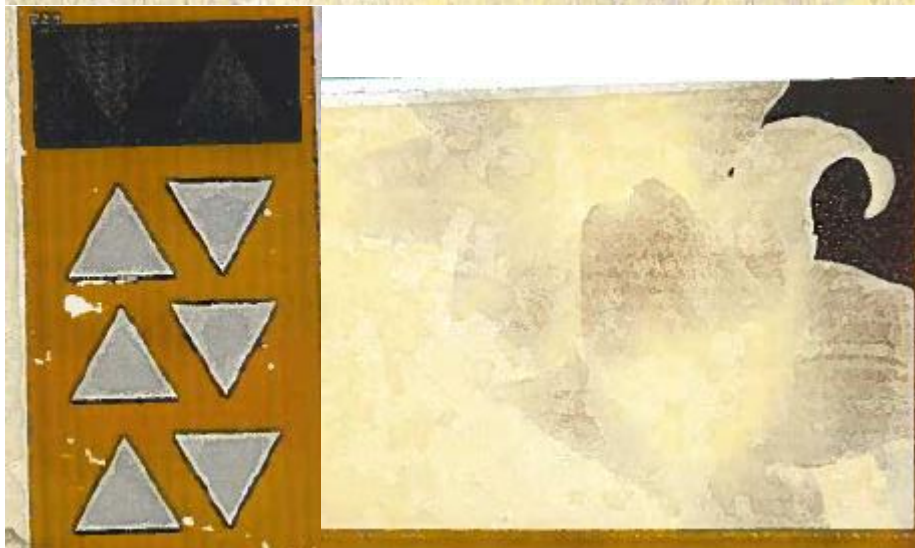
Kuva 1 Rullan 1 kirkkaat teipit KCL HSWO- koepainokoneen 4.painoyksikön yläpuolelta. Yläpuolella metsämaisema, rasteritaso 30 %, vasemmalla kolmioalue ja alhaalla oikealla rasterialue 50 % kukkakuvio.
