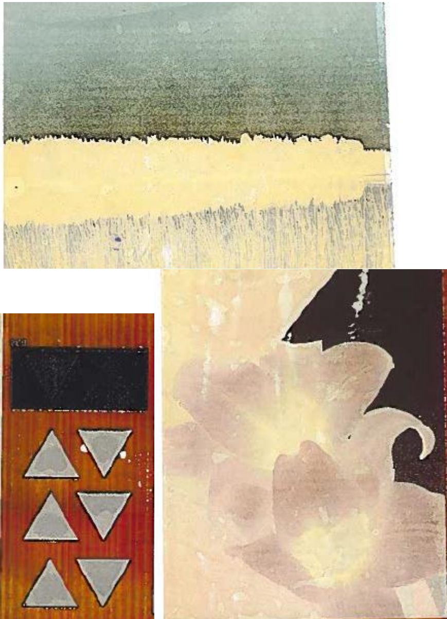
Kuva 4 Rullan neljä kirkkaat teipit KCL HSWO- koepainokoneen 4.painoyksikön yläpuolelta. Yläpuolella metsämaisema, rasteritaso 30 %, vasemmalla kolmioalue ja alhaalla oikealla rasterialue 50 % kukkakuvio.
