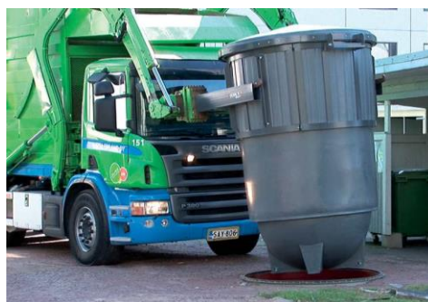
Kuva 14. Edestä tyhjennettävä syväkeräyssäiliö (Ecomp Oy 2010, 4).
