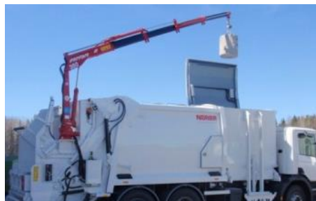
Kuva 24. Syväkeräyssäiliön tyhjennys (Flaaming Oy).
