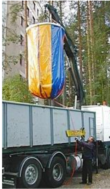
Kuva 25. Syväkeräyssäkin tyhjennys puominosturilla kuorma-auton lavalle (Ecomp Oy).
