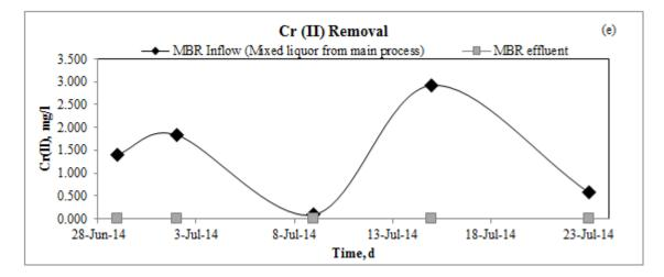
**Figure 32:** Influent and effluent concentration variations (a) Zn(II), (b) Cu(II), (c) Ni(II), (d) Pb(II) and (e) Cr(III)
