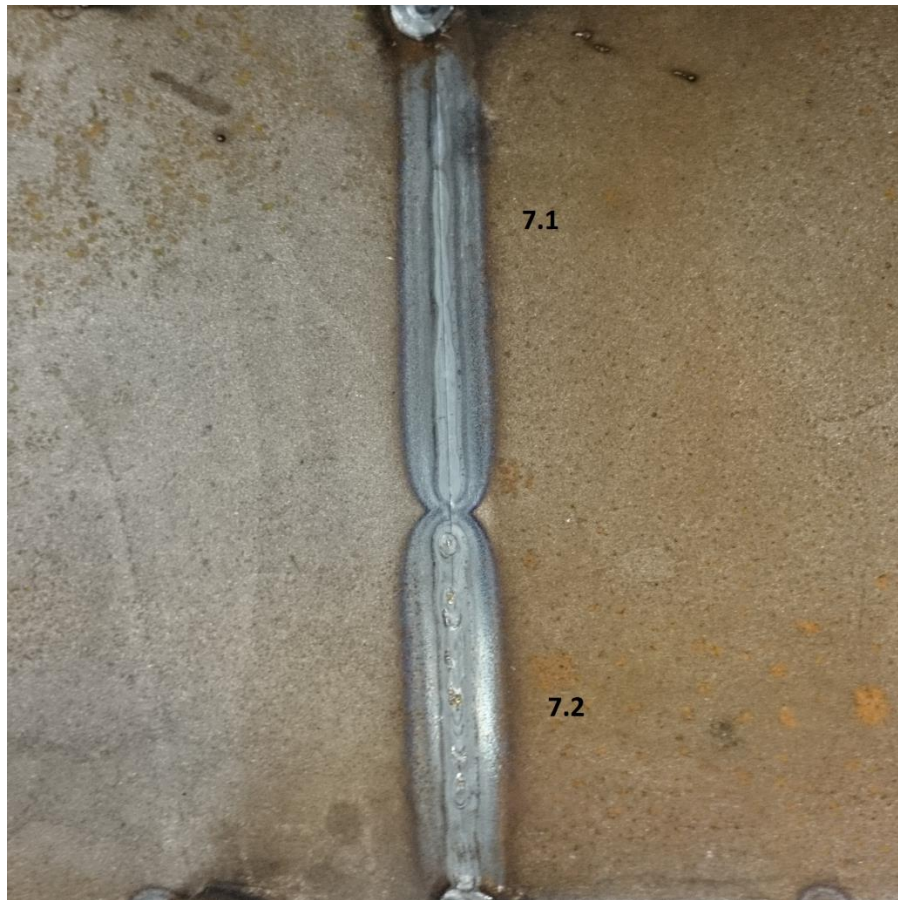
Kuva 19. Koekappaleen 7 juuren puoli. Ilmaraon leveys oli 0 mm ja juuripinnan korkeus 1 mm.
