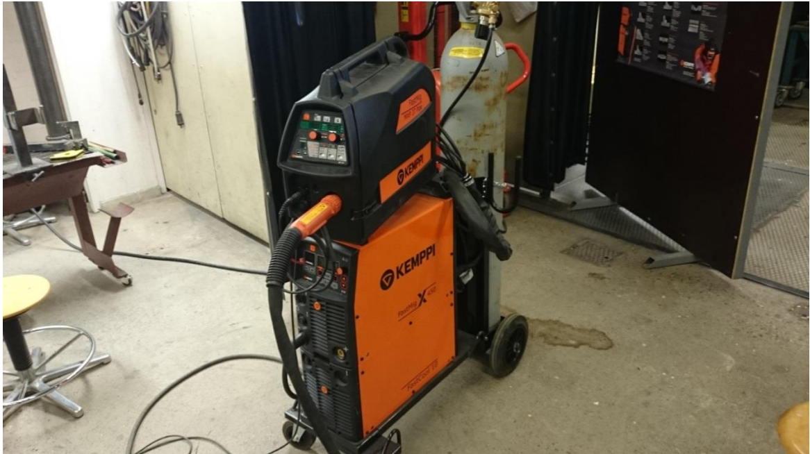
Kuva 9. Hitsauskokeissa käytetty Kemppi FastMig X 450 –virtalähde ja FastMig MXP 37 Pipe –langansyöttölaite.
