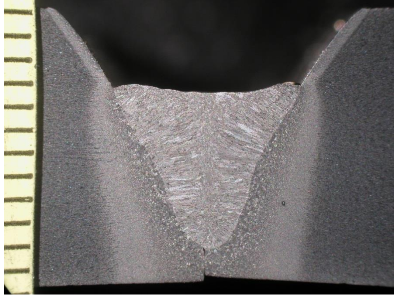
Kuva 15. Koekappaleesta 5.1 otettu hiekuva. Hie otettiin kappaleesta kohdalta, jossa ilmaraon leveys oli 0,5 mm. Juuripinnan korkeus oli 2 mm.
