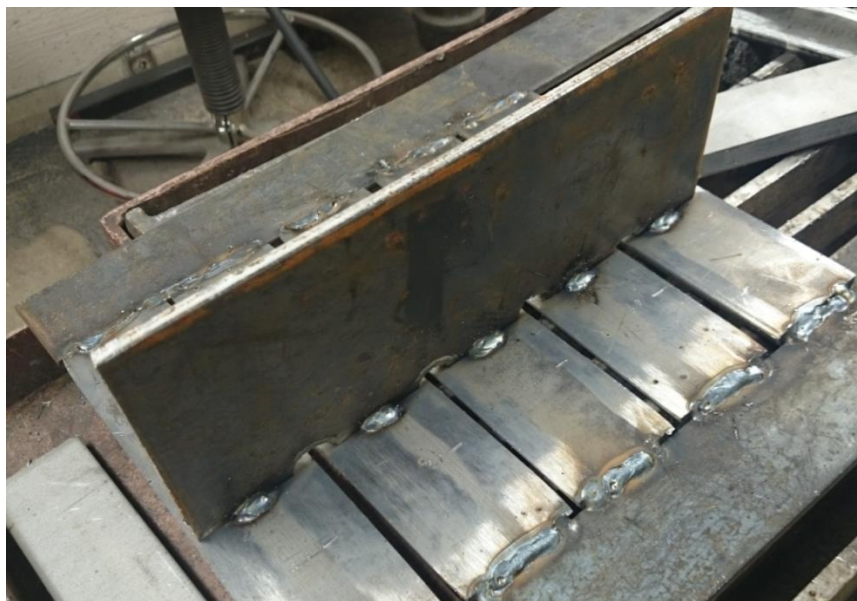
Kuva 11. Koekappaleen juuren puolelle hitsattu jäykistelevy. Jäykistelevyyn leikattiin urat railojen kohdalle.
