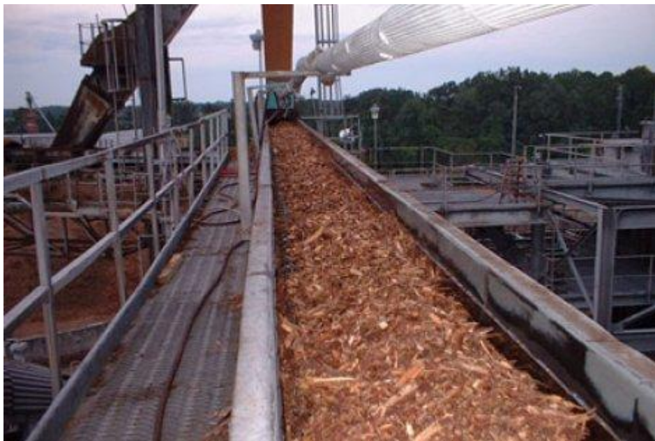
Kuva 30. Biomassan kuljetusta hihnakuiljettimellä (Process Barron)
