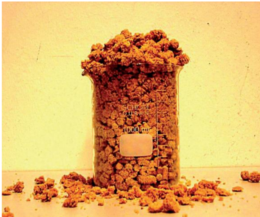
Kuva 41. Veden lisäyksen aiheuttama turpoamiseksi pelleteissä. (IEA Bioenergy, 2013)
