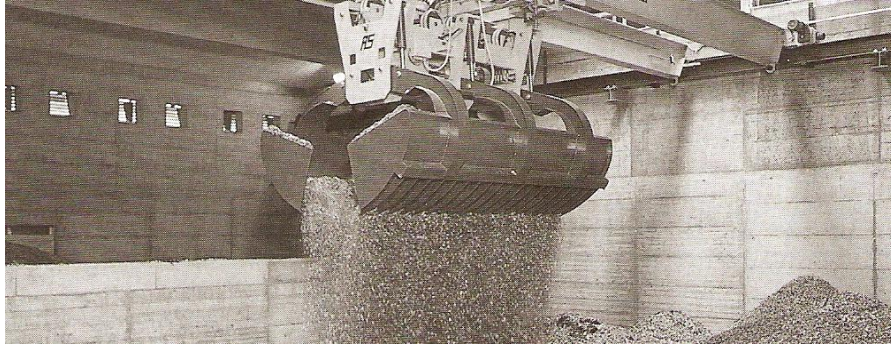
Kuva 29. Hakkeen käsittelyä nosturijärjestelmällä välivarastossa (Van Loo & Koppejan, 2008)
