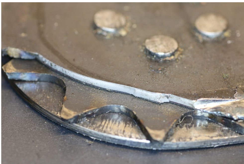
Kuva 23. Merkkejä haurasmurtumasta kaksoiskarkaisun rajalla.
