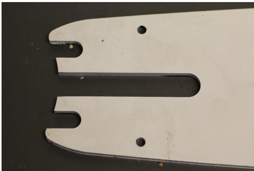
Kuva 15. JetFit –kiinnitys laipan perässä.
