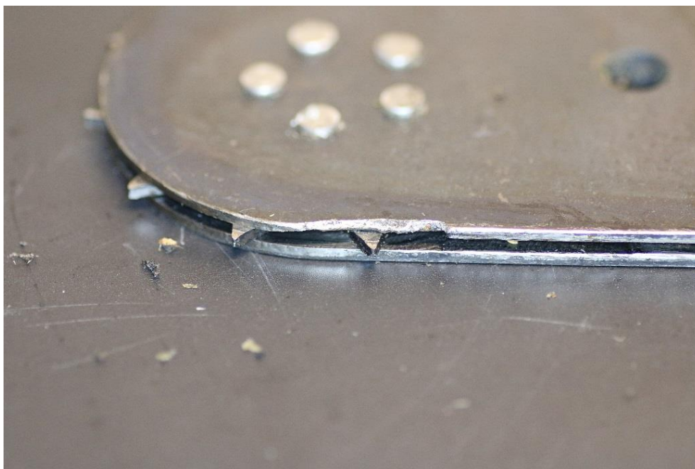
Kuva 24. Toinen koeajettu laippa irrotettuna rikkoutumisen jälkeen.
