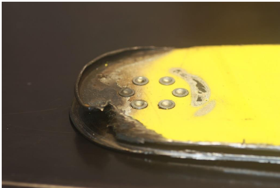
Kuva 10. Erittäin pahoin vaurioitunut kärki ja vaurion syy-seurausketju.
