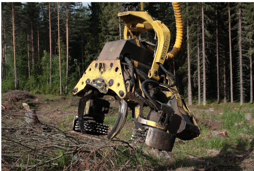
Kuva 21. Koeajossa käytetty hakkuupää Waratah H480C.
