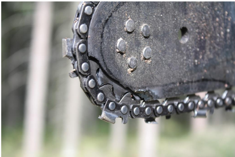
Kuva 22. Ensimmäinen koeajettu laippa heti rikkoutumisen jälkeen.
