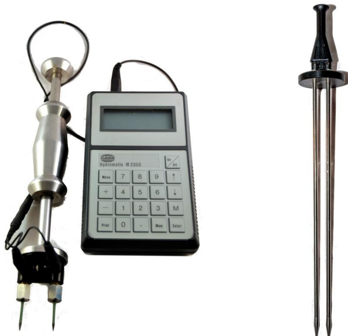
Kuva 13. Pikakosteusmittari Hydromette M 2050 sekä mittauspäät M18 kiinteänpuun mittaukseen (vasemmalla) ja HS 500 hakkeen mittaamiseen (oikealla). Mittalaitteet eivät ole mittakaavassa.
