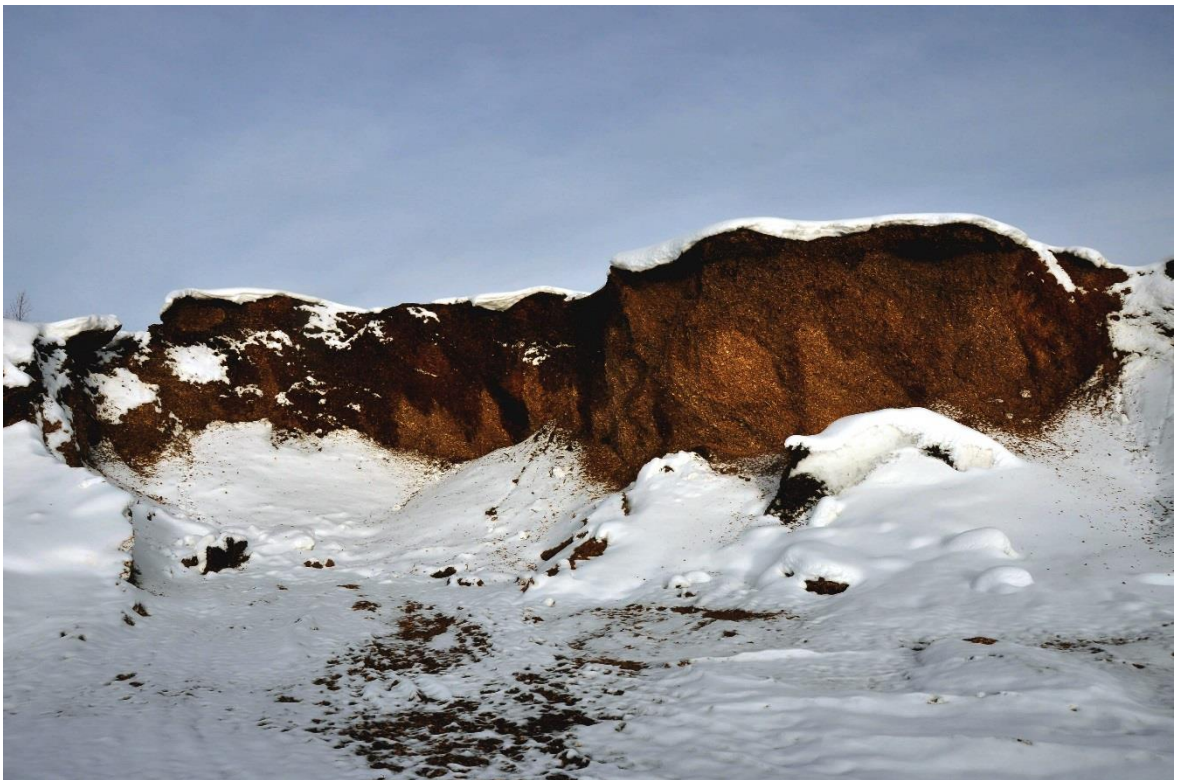
Kuva 12. Kurkвуoren terminaalin hakeaman purkukohta. Kosteuskertymä näkyvissä selkeästi varjossa.
