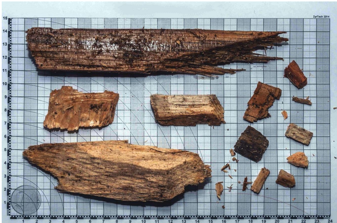
Kuva 15. Metsä-Sairilan hakkeen kokoluokka. Samaa kokoluokkaa oli muissakin hakevarastoissa. Neljä suurinta haketta valittiin käsin erityisesti kuvausta varten. Oikeassa alalaidassa on yleinen palakoko hakkeelle.
