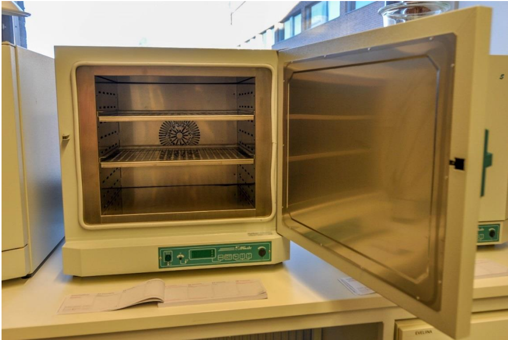
Kuva 17. Kosteuspitoisuuden määrittämiseen käytettävä Termaks TS8000 lämpökaappi.
