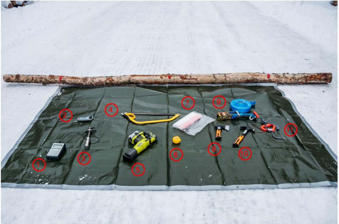
Kuva 16. Mittaus- ja näytteenottopiste yksittäisestä rangasta. Rangan edessä käytettävä välineistö mittauksissa ja näytteenotossa. (1.) Hydromette M2050 (2.) Koukkuvaaka (3) M18 -mittapää (4) Kaarisaha (5) Puukkosaha (6) Rullamitta (7) Näytepusseja (8) Kirves (9) Sidontaliina (10) Vasara (11) Tukkipihdit ja -koukku.
