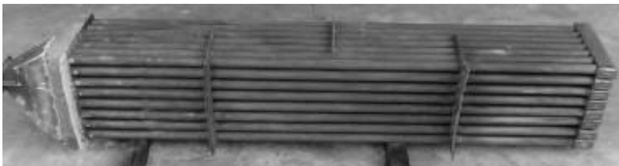
Kuva 21. Putkivaippa-lämmönsiirrin ominaisuuksia (Al-attab K 2010).
