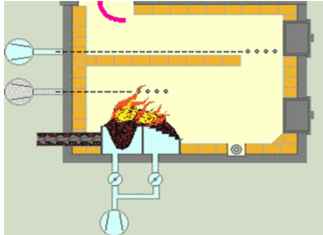
Kuva 19. Alapalokattila. (Riccio et al 2011).
