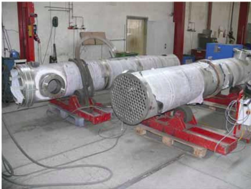
Kuva 20. Putki-vaippatyypinen lämmönvaihdin. (Riccio et al 2011).
