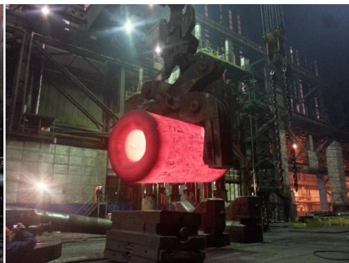
Kuva 3: VVER reaktorin esivalmistusteräksen sulatus (a) ja esivalmisteiden muovaus (b)
