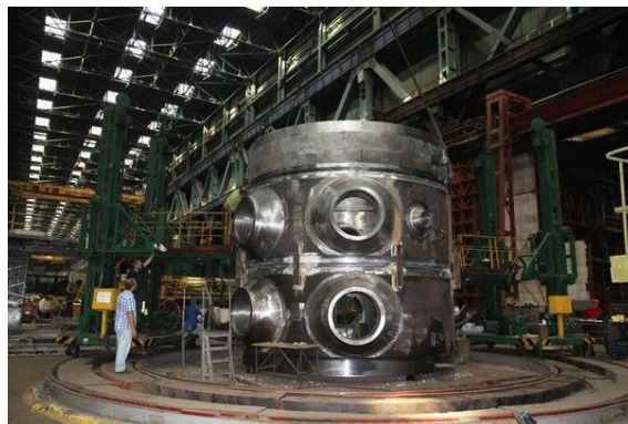
Kuva 4: VVER reaktorin esivalmistusrenkaan koneistus
