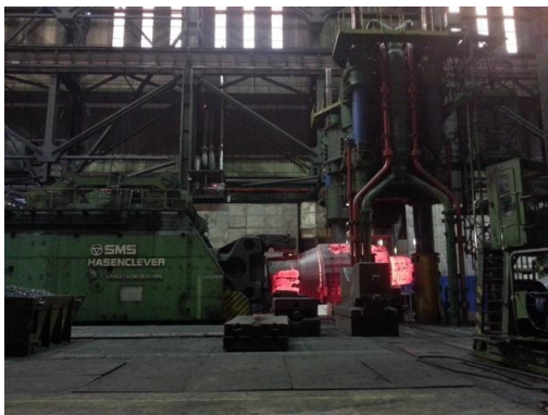
Kuva 3: VVER reaktorin esivalmistusteräksen sulatus (a) ja esivalmisteiden muovaus (b)
