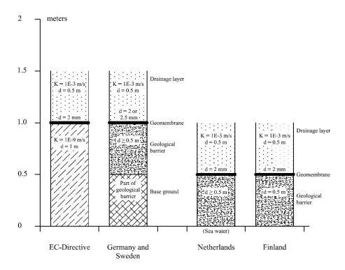
Fig. 6. MSW landfill bottom layer conceptual structural demands based on the Landfill Directive 1999/3i, in Germany (*DepV*, 2002), in Sweden (SFS nr 2001: 512), in the Netherlands (*Richtlijnen onderafdichtingsconstructies voor stort- en opslagplaatsen*) and in Finland (VNp 861/97) (K is the hydraulic conductivity, d the thickness).
