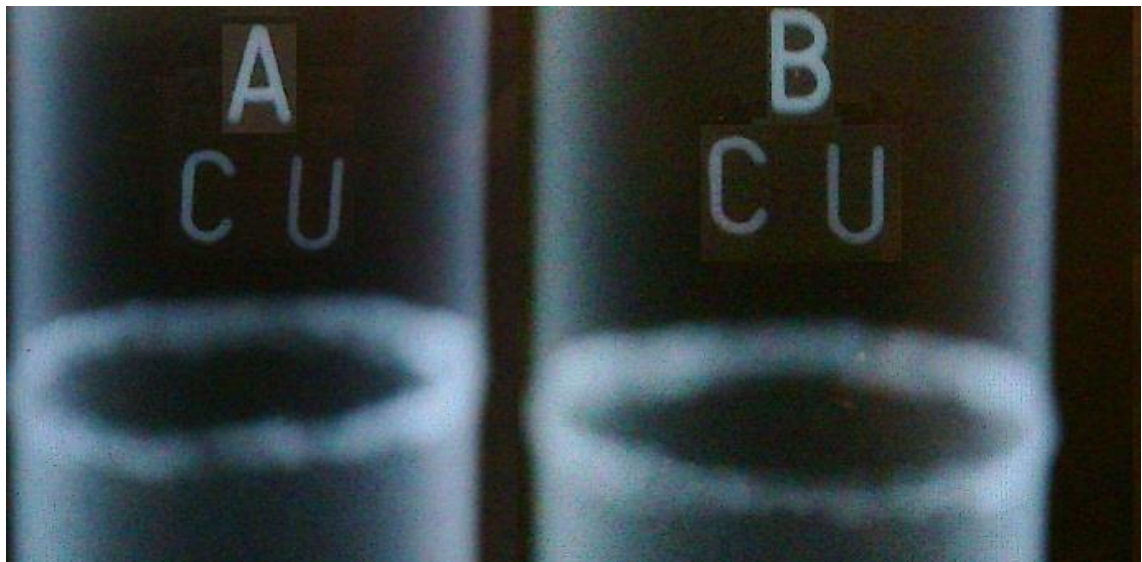
Kuva 42. Eripariliitoskoekappale 5 röntgenkuvissa. Hitsissä ei havaittu huokosia tai halkeamia.
