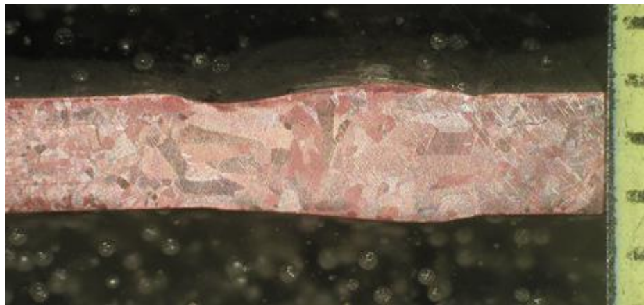
Kuva 53. Ilman lisäainetta hitsattu Cu-Cu-liitos. Hitsissä on suuri raekoko, ja vajaa kupu erottuu selvästi.
