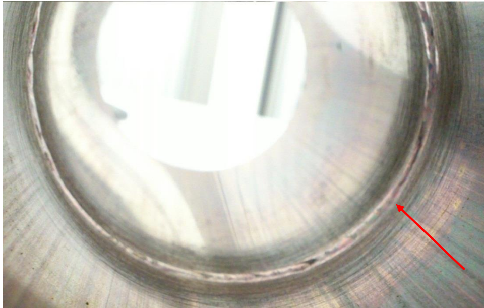
Kuva 24. Kuparikoekappale 2 juuren puolelta. Juuri on muodostunut hyvin.
