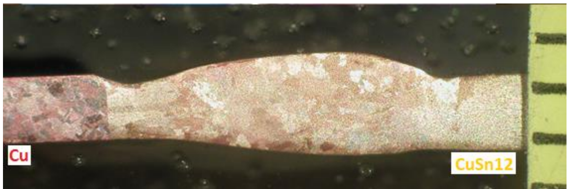
Kuva 59. Ilman lisäainetta hitsattu Cu-CuSn12-eripariliitos. Kuparin puoli on sulanut huonosti tinapronssiin verrattuna.
