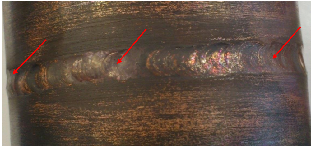
Kuva 23. Kuparikoekappale 2 pinnan puolelta. Hitsissä on vajaata kupua.
