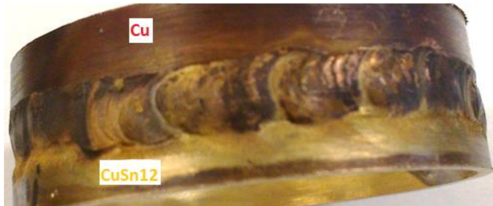
Kuva 33. Eripariliitoskoekappale 2 pinnan puolelta. Reunahaavaa on vähemmän, mutta vajaata kupua on edelleen.
