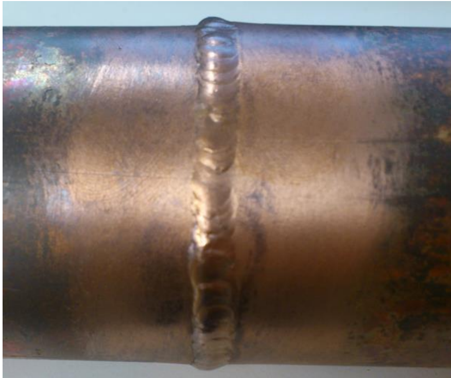
Kuva 29. Kuparikoekappale 6 pinnan puolelta harjauksen jälkeen. Pinta on onnistunut hyvin.
