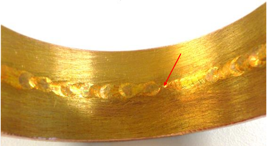
Kuva 22. Kuparikoekappale 1 juuren puolelta. Hitsautumissyvyys on aloituskohdassa jäänyt vajaaksi.
