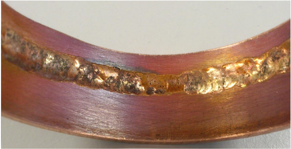
Kuva 26. Kuparikoekappale 3 juuren puolelta. Juuri on selvästi onnistunut pintaa paremmin.
