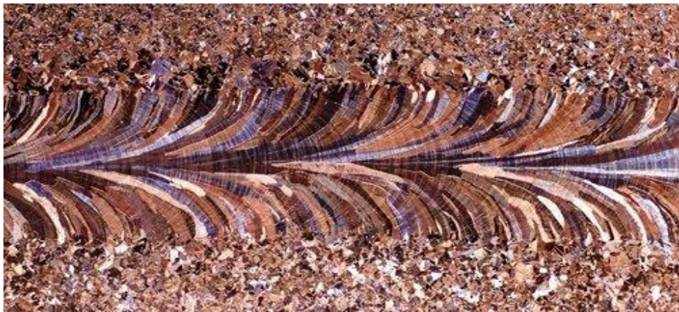
Kuva 11. Elektronisuihukilla hitsattu kupariliitos (Tampere University of Technology, 2013).
