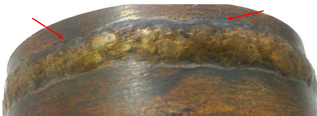
Kuva 25. Kuparikoekappale 3 pinnan puolelta. Hitsi on kuoppainen ja sen reunoilla on reunahaavaa. Reunahaava on merkitty nuolilla.
