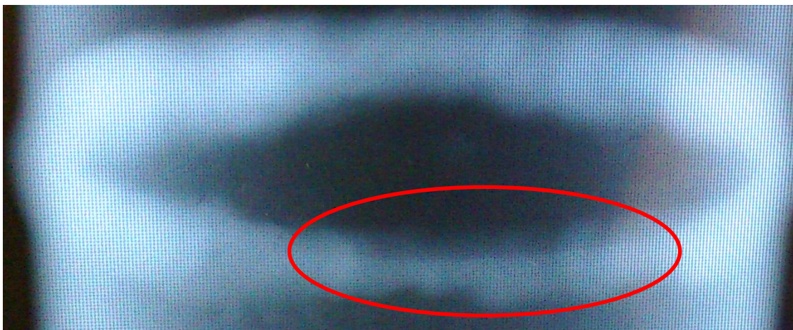
Kuva 43. Vajaata hitsautumissyvyyttä eripariliitoskoekappaleen 5 röntgenkuvassa.
