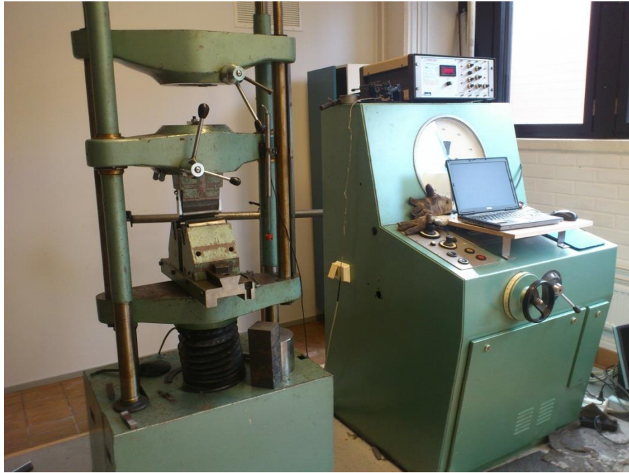
Kuva 44. Veto- ja taivutuskokeiden laitteisto.
