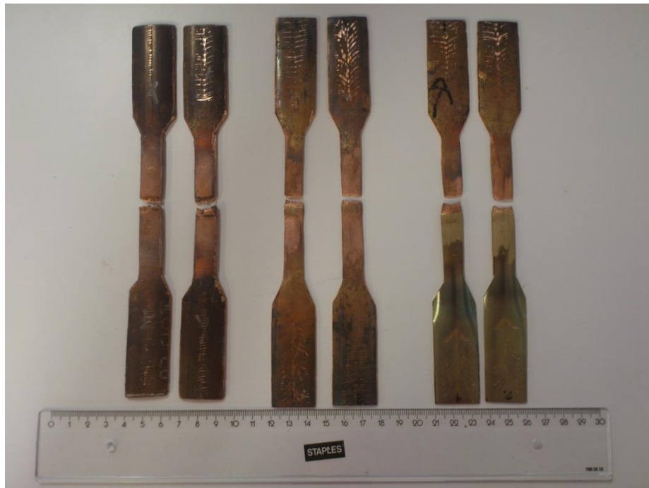
Kuva 45. Vetokoesauvat testauksen jälkeen. Vasemmalla on ilman lisäainetta hitsattu kupariliitos, keskellä lisäaineella hitsattu kupariliitos ja oikealla lisäaineella hitsattu eripariliitos.
