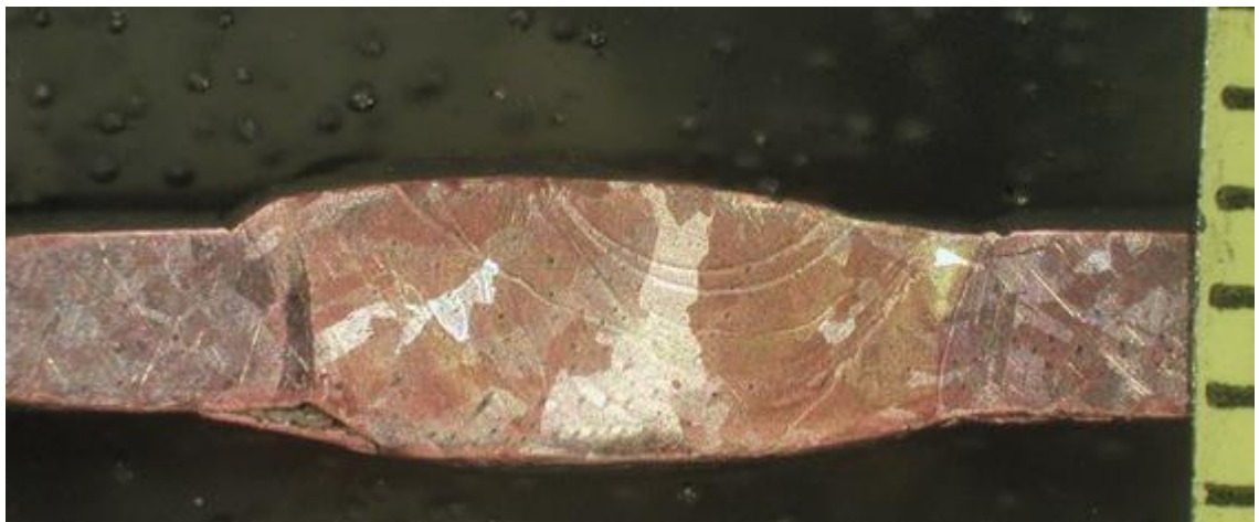
Kuva 55. CuAl8-lisäaineella hitsattu Cu-Cu-liitos. Hitsi on huokoinen, ja lisäaine on seostunut huonosti perusaineeseen.
