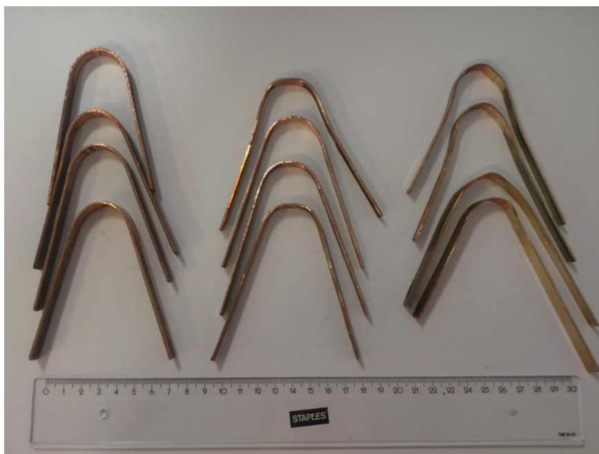
Kuva 46. Taivutuskoesauvat testauksen jälkeen. Lisäaine on lujittanut hitsejä. Vasemmalla on ilman lisäainetta hitsattu kupariliitos, keskellä lisäaineella hitsattu kupariliitos ja oikealla lisäaineella hitsattu eripariliitos.
