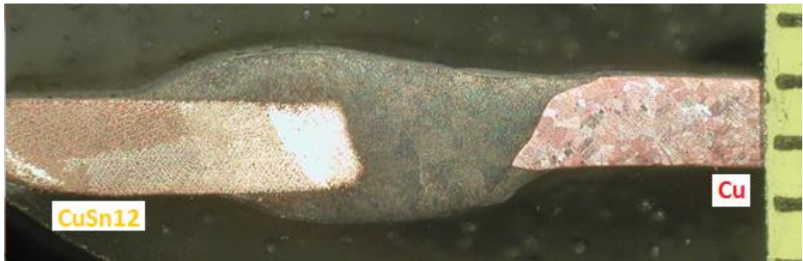
Kuva 61. CuP-lisäaineella hitsattu Cu-CuSn12-eripariliitos. Lisäaine on sekoittunut heikosti perusaineisiin.
