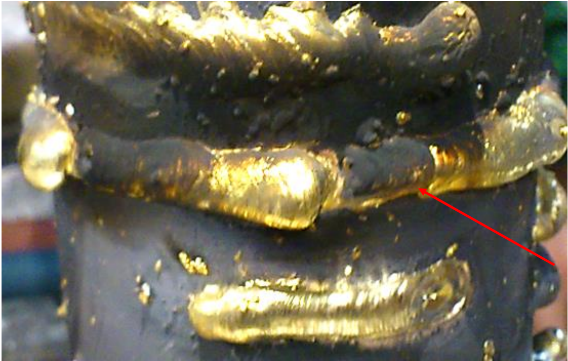
Kuva 27. Kuparikoekappale 4. Hitsaaminen on ollut heikosti hallittua. Railoon hitsattu hitsi on merkitty nuolella.
