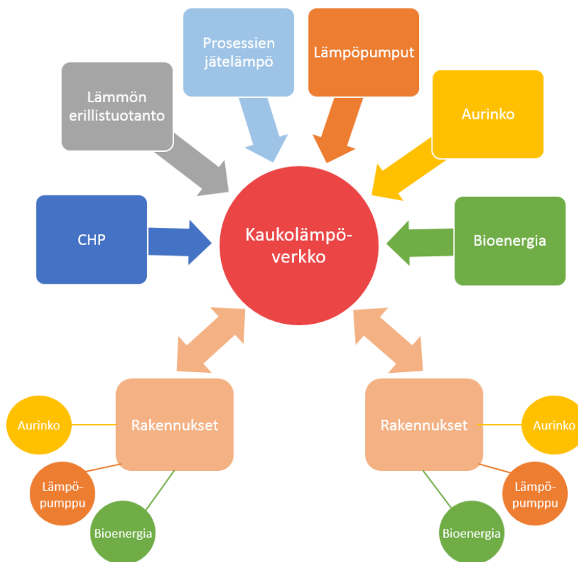
Kuva 12. Kaksisuuntaisen kaukolämpöverkon toimintamalli.
