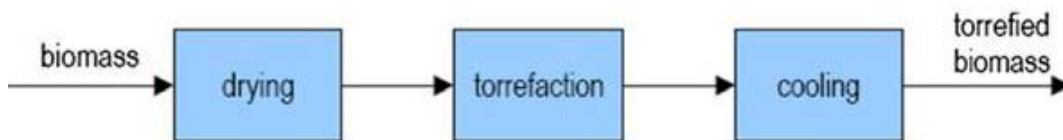
Kuva 3 Torrefiointiprosessin periaate (Van der Stelt et al. 2011).
