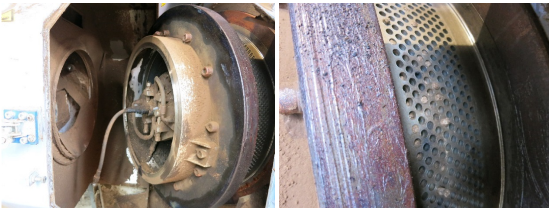
Kuva 8 Pelletöinnissä käytettävä rautamatriisi Torrec Oy:n pilottilaitoksella.
