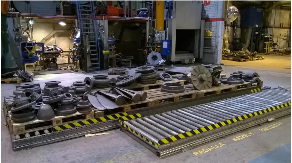
Kuva 9. FI-FO-läpivirtausvarasto käsinpuhdistukseen jonottaville valukappaleille. Kuvan kappaleet ovat edenneet valukkeiden termisen sekä mekaanisen poiston jälkeen lämpökäsittelyyn ja edelleen sinkopuhalluksen jälkeen käsinpuhdistukseen.
