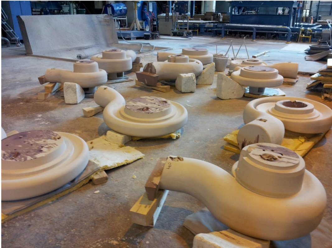
Kuva 4. Spiraalipumppujen pesien keernoja odottamassa asennusta valumuotteihin Karhulan valimossa 2015.
