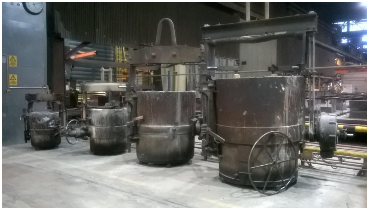
Kuva 7. Erikokoisia senkkoja sulien siirtelyyn. Kuva on otettu Karhulan valimossa 2015.
