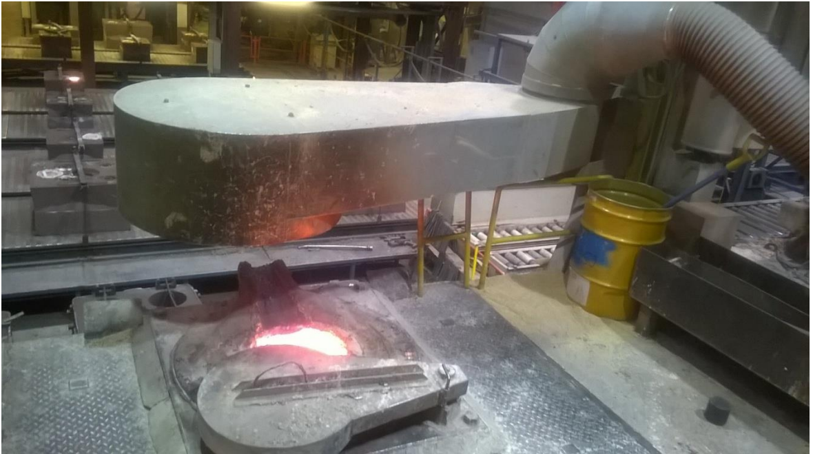
Kuva 8. 1,5 tonnin induktiouuni kuvattuna sen ylätasanteelta. Uuni on panostettu ja sulatus on käynnissä. Savunpoistojärjestelmä on panostusluukun yläpuolella. Kuva on otettu Karhulan valimossa 2015.
