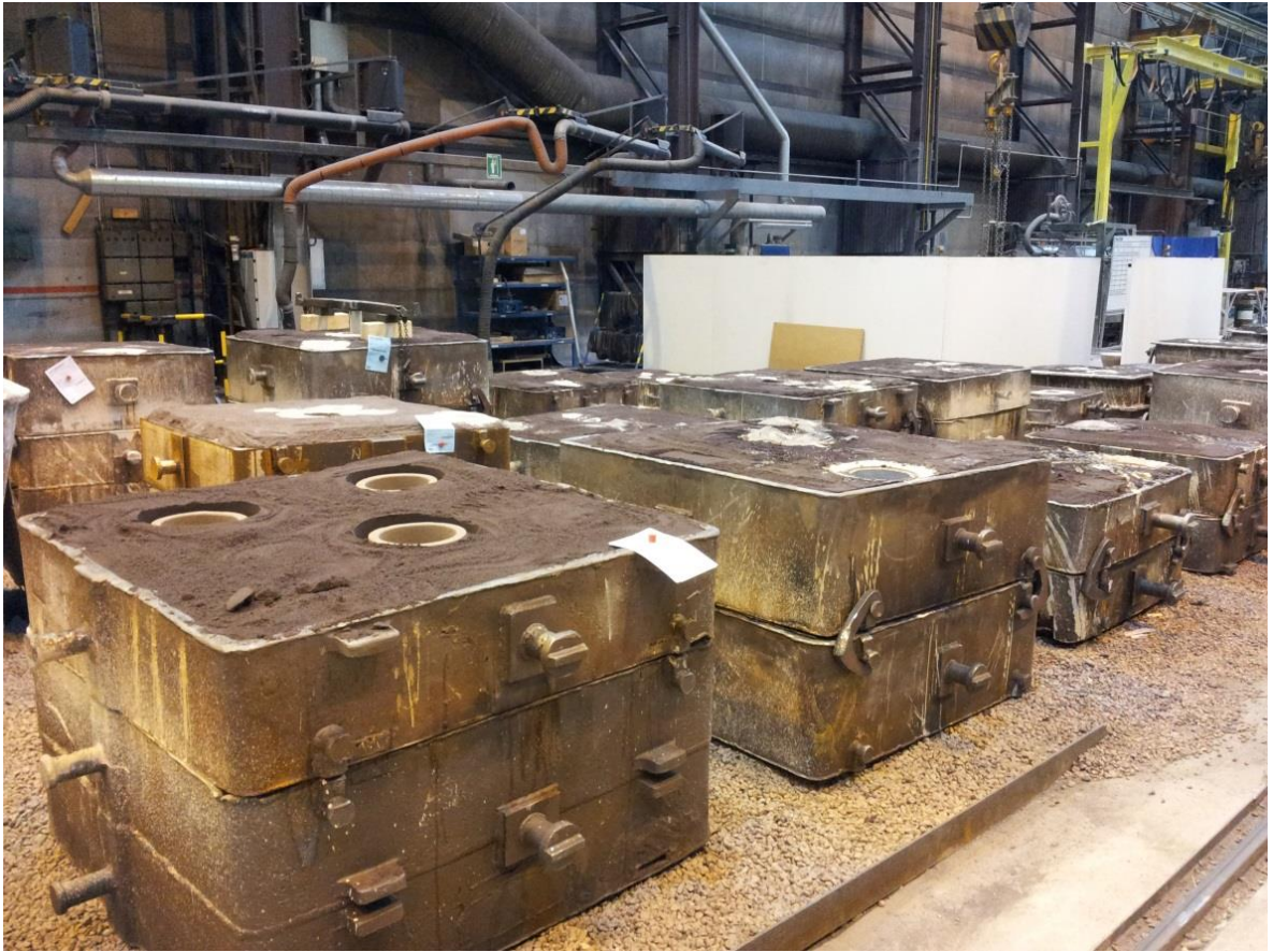
Kuva 3. Erikokoisia käsinkaavattuja kehyksellisiä muotteja, joista osa on valettu ja osa odottaa yhä sulaa. Kuva on otettu Karhulan valimossa 2015.
