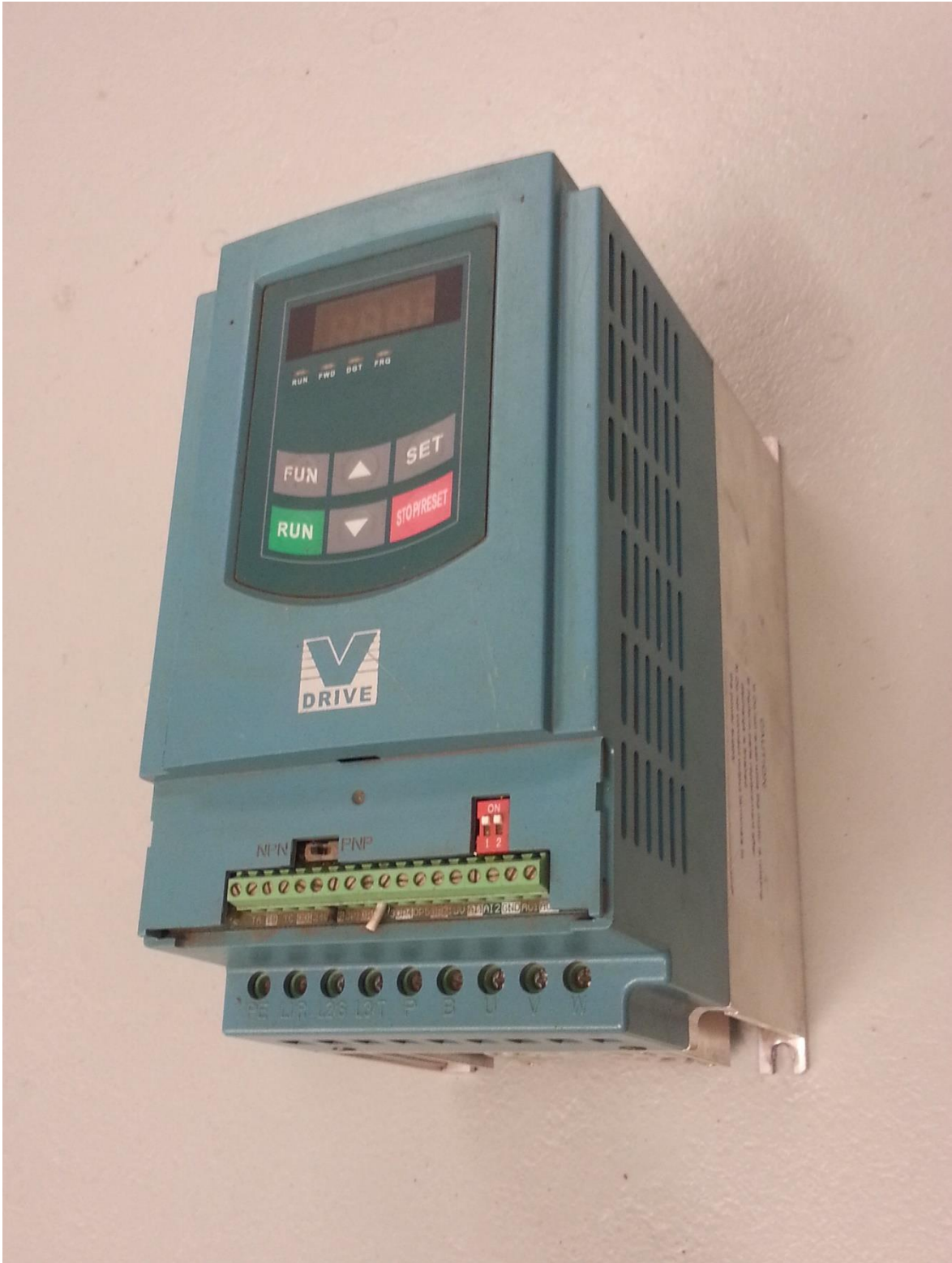
Kuva 13. V-Drive VDE-40007 taajuusmuuttaja, jonka lähtöteho on 0.75 kW ja lähtötaajuus 0 Hz – 650 Hz.
