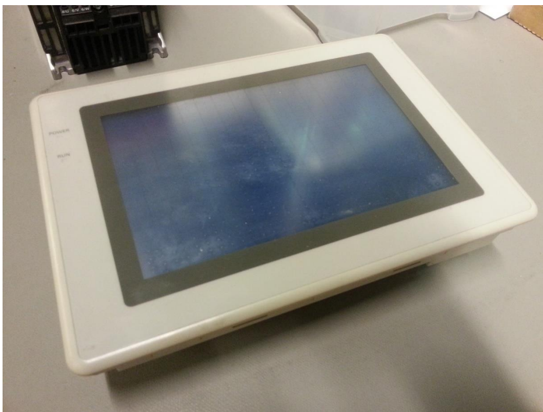
Kuva 16. Kuvassa on esitetty Omron NT600s-sarjan ohjelmoitava HMI-paneeli. Korjauksen lähtötietona oli, että paneeli toimi muuten moitteettomasti, mutta sarjaliikennekaapelilla ei saanut yhteyttä paneeliin.
