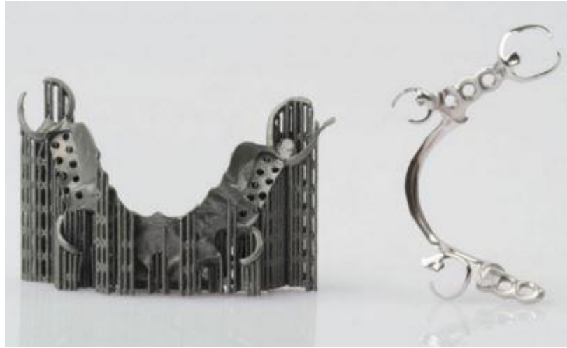
Kuva 9. Kuvassa EOS:n laitteistolla, jauhepetimenetelmällä valmistettu hammastuki. Vasemmalla tuki ilman vaadittavien tukirakenteiden poistoa ja oikealla jälkikäsiteltynä. (Mukaiillen Additive Manufacturing, 2013.)
