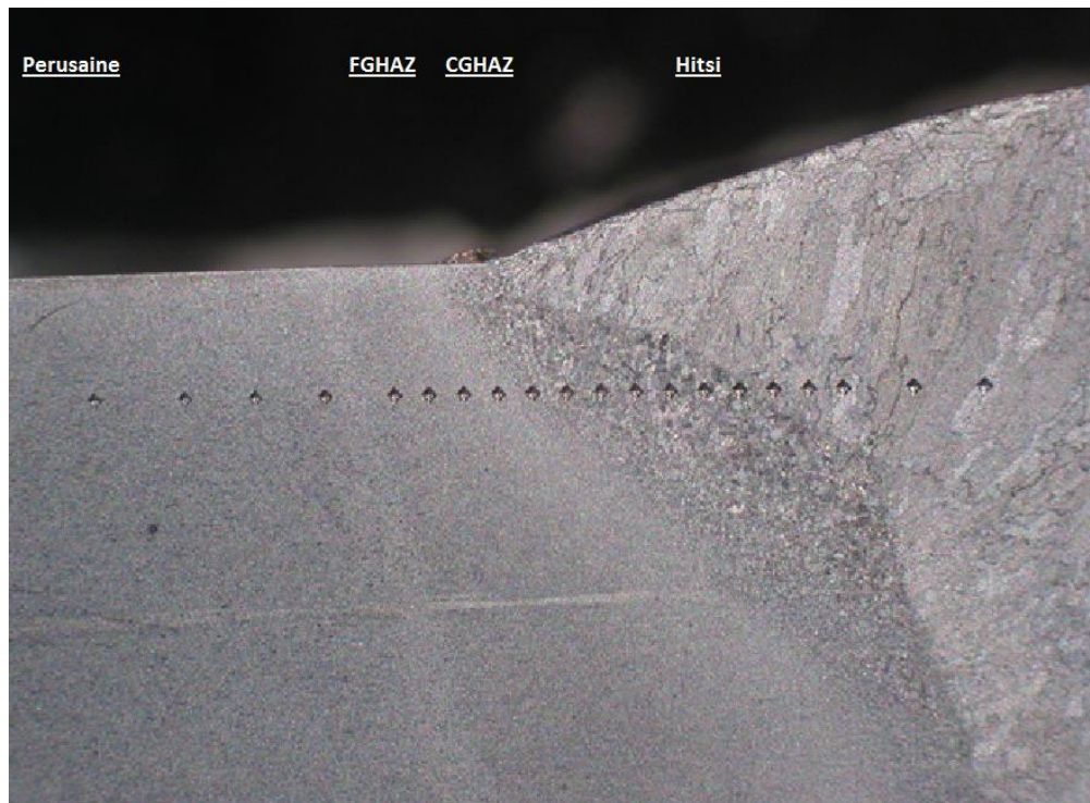
Kuva 5. Makrokuvaa samasta hitsistä kuin kuvassa 4.
