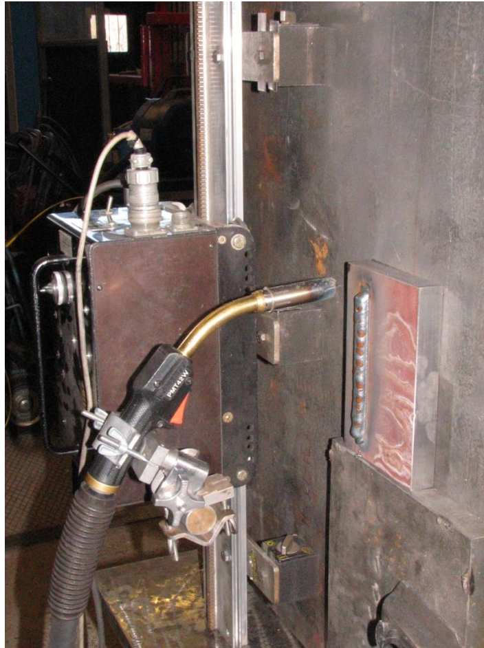
Kuva 16. Lähempi kuva käytetystä kuljettimesta ja hitsauspistoolin kiinnityksestä siihen.
