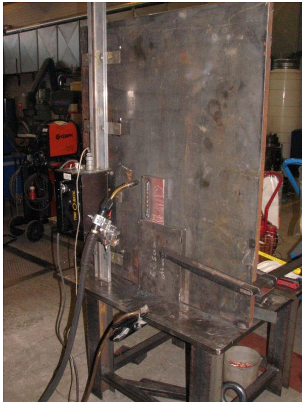
Kuva 15. Hitsausjärjestelyt. Hitsaus tapahtui pystyasennossa alhaalta ylöspäin.
