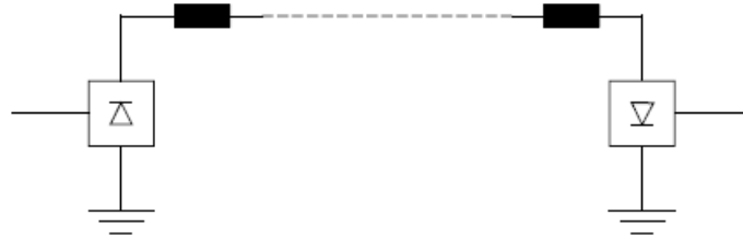
Kuva 2.1. Monopolaariyhteys ilman erikseen rakennettua paluujohdinta. (Partanen 2014b)
