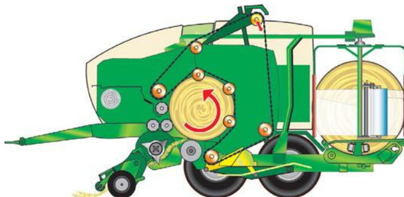
Kuva 3.22 Esimerkki paalainkäärimellisestä pyöröpaalaimesta. [37]
