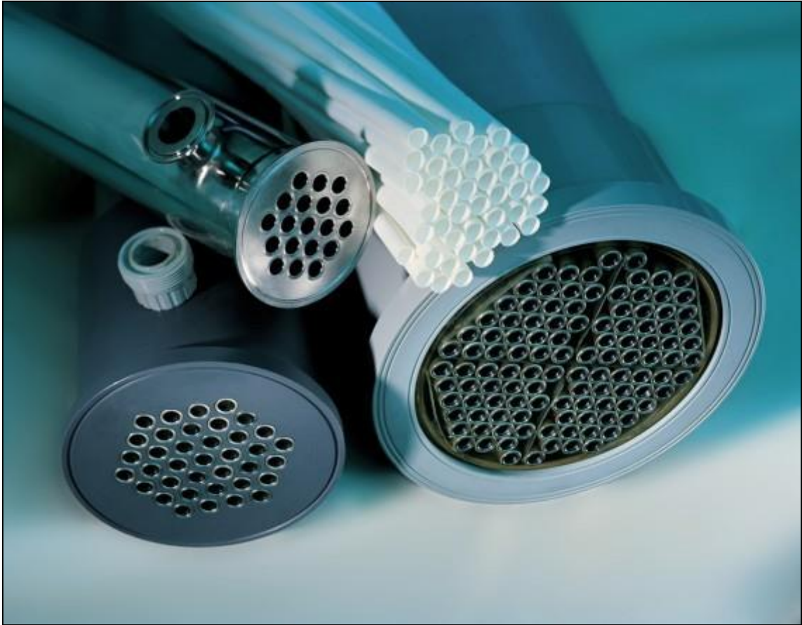
Kuva 26: Putkimallinen kalvosuodatin. Puhdistettava neste virtaa pienempien putkien sisällä ja puhdistettu permeaatti poistuu yksikön kyljestä olevasta aukosta. (Forward Osmosis Tech 2016.)
