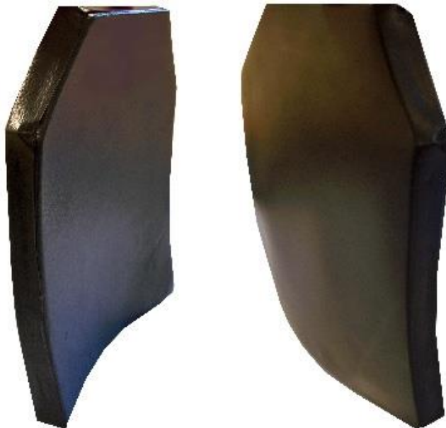
Kuva 8. Tyypillisiä kaupallisesti saatavissa olevia ABS-pinnoitettuja boorikarbidilevyjä (Global Armour, 2016).
