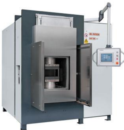
Kuva 1. Boorikarbidituotteiden valmistamiseen käytettävä kuumapuristuslaite (Industrial Heating, 2016).
