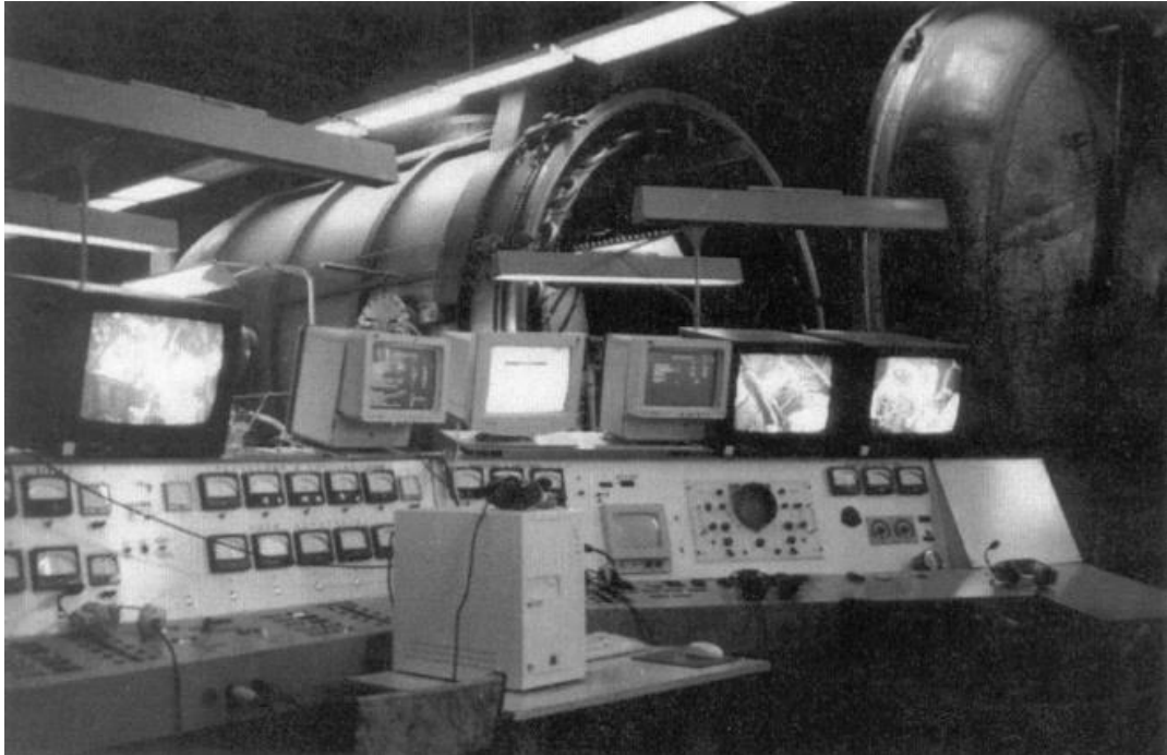
Kuva 7. TBK–50-niminen avaruusolosuhteita simuloiva kammio (Russell, Malone & Cato 2004, s. 2).
