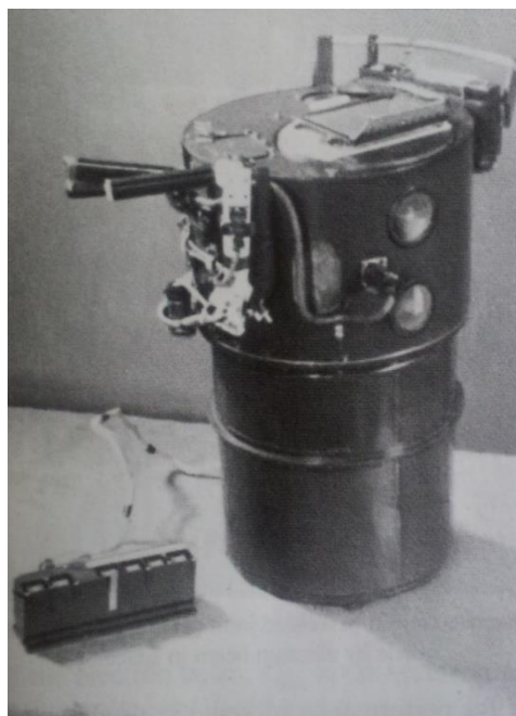
Kuva 11. Vulkan-hitsauslaitteisto (Paton & Kubasov 1970, s. 159).
