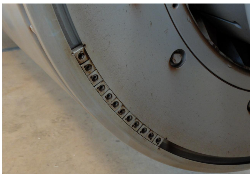
Kuva 33. Roottorin päähän sijoitetut tasapainotuspainot.
