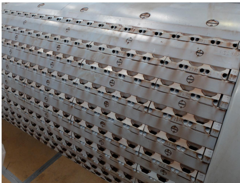
Kuva 32. Roottorin kyljissä olevat tasapainotuspalaset.
