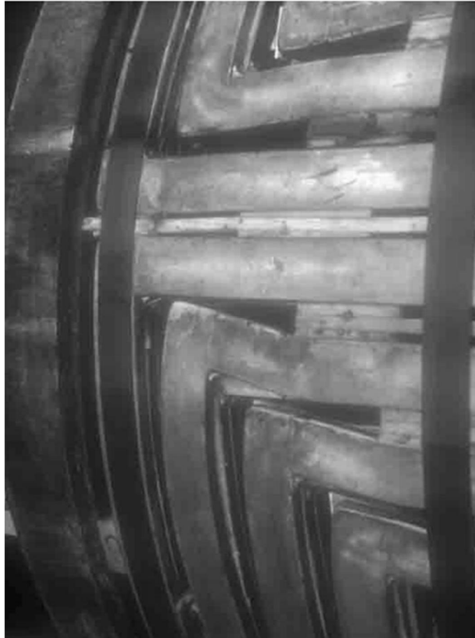
Kuva 35. Kääminpäät joissa 90^\circ , kuvassa nähdään käämien kierrossulku. (Klempner 2004 s.430)
