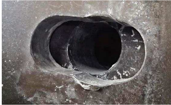
Kuva 28. Kuluminen ruostumattoman tukikehän hahlon pinnalla.
