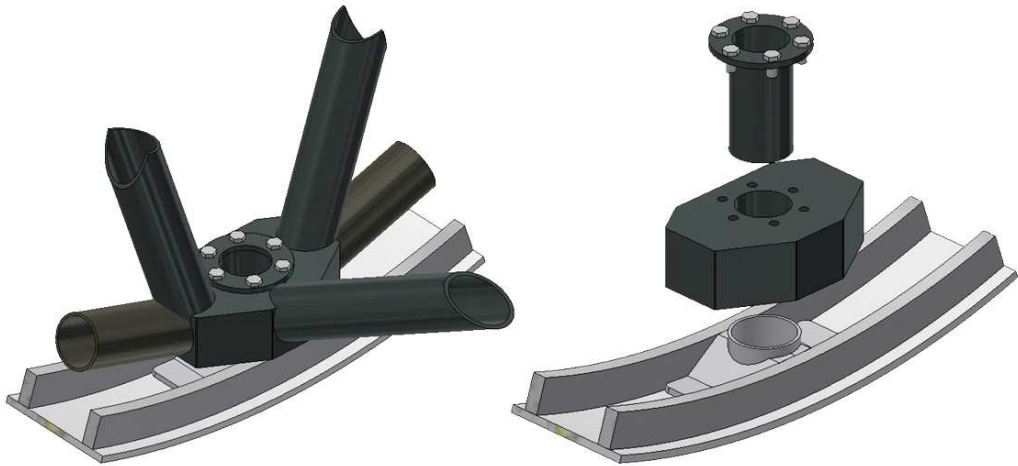
Kuva 44. Ratkaisuvaihtoehto 6 leikkauskuva. Oikealla valuosa ja rakenneputket.
