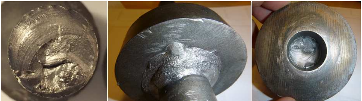
Kuva 23. Vasemmalla kuva tapin murtumapinnasta, keskellä aluslevyn ja tapin pienahitsi ja oikealla tapin aluslevyn sisälle jäävä murtumapinta.
