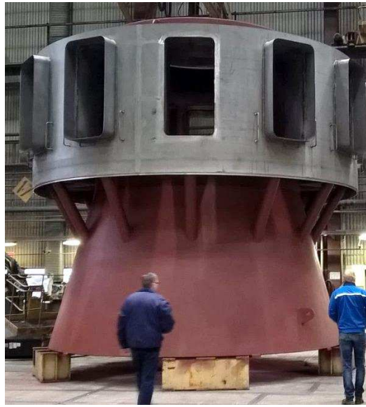
Kuva 6. Uunin kartio-osa sekä jäähdyttimen sisäsynterinin osa.
